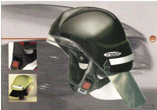
Ein anderes Modell der Firma CASCO Schutzhelme. Der PF 1000 mc erfüllt den schwedischen Standard mit Dauerbelastungswerten von 280° C Umgebungstemperatur und eine Wärmestromdichte von bis 40 kW/m<sup>2</sup>.
