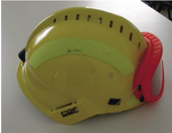
**DRÄGER Waldbrandhelm**, Farbe gelb, verwendet von 2004 bis heute, samt integrierter Schutzbrille mit Silikonbebänderung, durchgehende Bebänderung, Helmoberfläche mit gelben nachleuchtenden Streifen, Type CGF Gallet®, Made in France, Prüfzeichen CE0049, geprüft in der Spezifizierung UIAA (Sicherheitsnorm für Bergsportausrüstung), Gewicht 580 g, Stempel „Gallet S.A. NIT 266“ Hersteller Gallet als Produzent für Dräger
