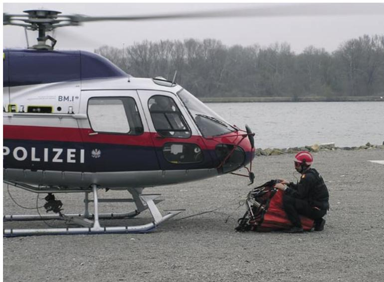
Aufnahme 500 Liter Bambi-Bucket durch Eurocopter ECUREUIL SA355N, Sicherung des Bambi-Buckets durch den Flughelfer vor dem Rotorabwind, Helm F2 Prototyp mit Hörsprechgarnitur, 21.4.2007 Einsatzpilotenschulung beim neuen Hafen der Landesfeuerwehrschule in Tulln
