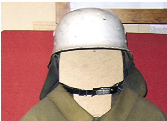
*Abb.: Feuerschutzhelm, umgespritzt mit weißem PUR-Lack*
