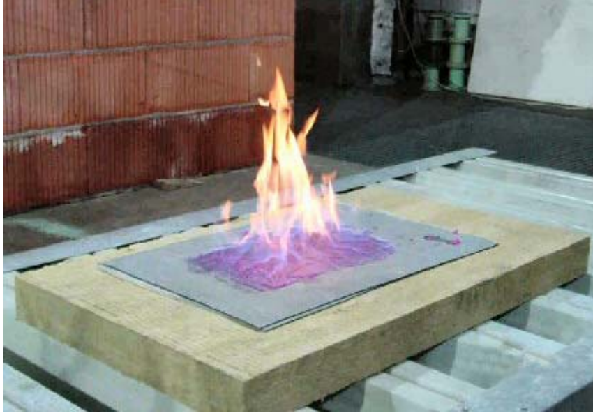
Bild 10.1: Zündversuch von Bitumen-Dachbahnen mittels auf die Oberfläche aufgetragener, handelsüblicher Brennpaste.
