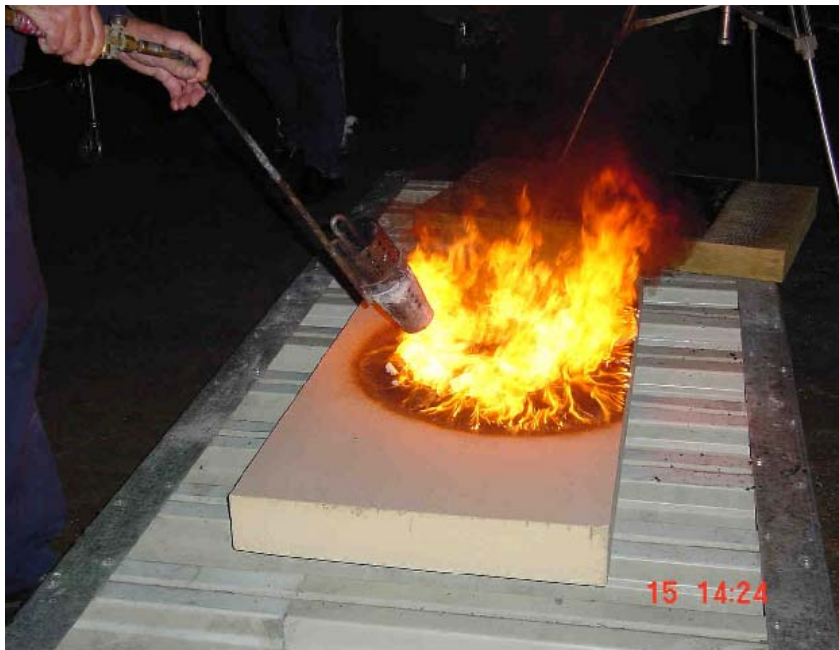
Bild 10.2: Zünden der Beschichtung einer Polyurethan / Polyisocyanurat-Wärmedämmplatte (PUR / PIR) mittels eines Dachdeckerbrenners
