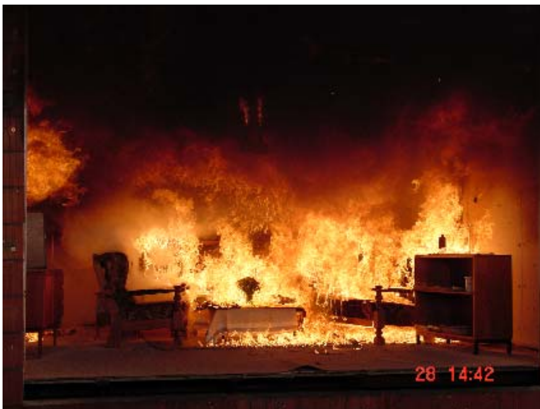
Bild 11.3: Flashover nach 12:18 min Branddauer
