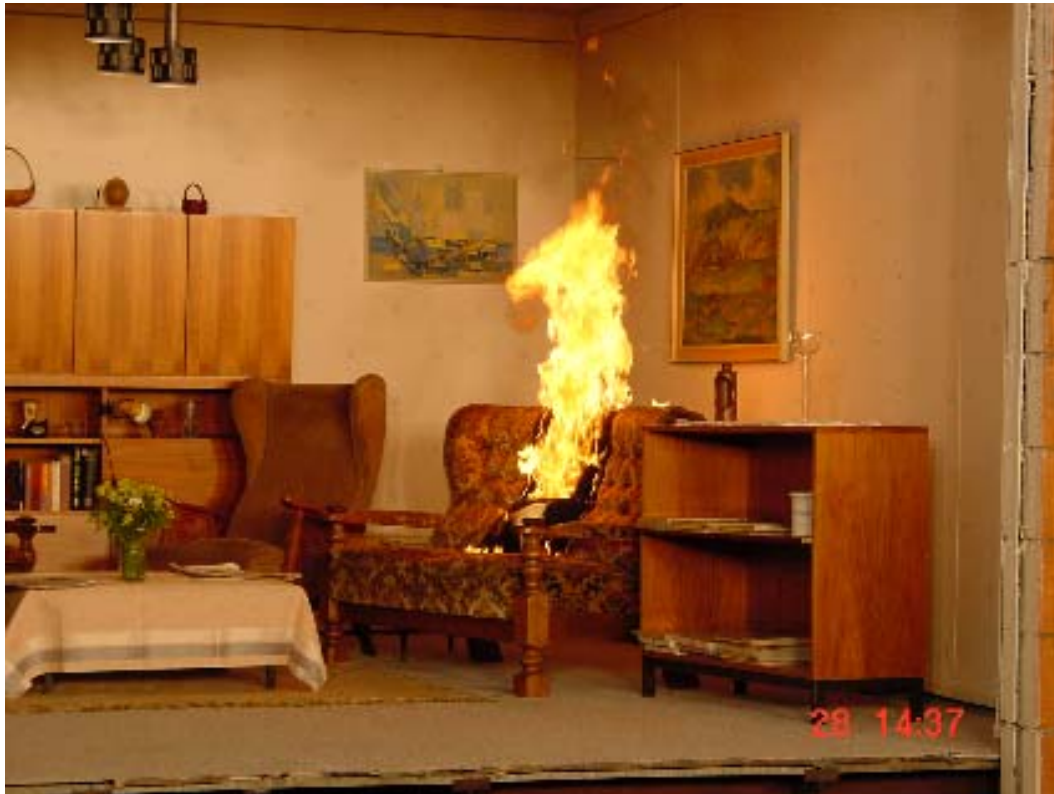
Bild 11.2: Flammenszenario 7 min nach der Zündung
