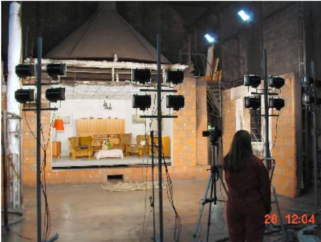
Bild 11.1: Versuchsstand mit möbliertem Brandraum und Beleuchtungseinrichtung.
