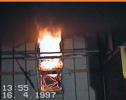
Außenfassade: Zerstörung der unteren ESG-Scheibe nach 7 min 50 s
