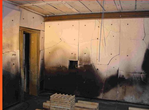
Brandraum mit Stahlträger 3 und Brandraumtür
