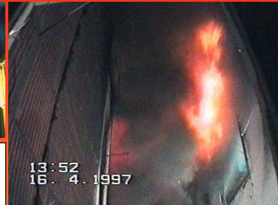
Zwischenfassadenbereich: direkte Beflammung der Außenfassade,
