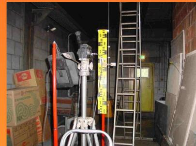
Messung der Durchbiegung von Stahlträger 1
