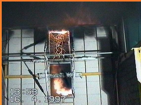
Außenfassade: Zerstörung der oberen ESG-Scheibe nach 5 min 53 s,
