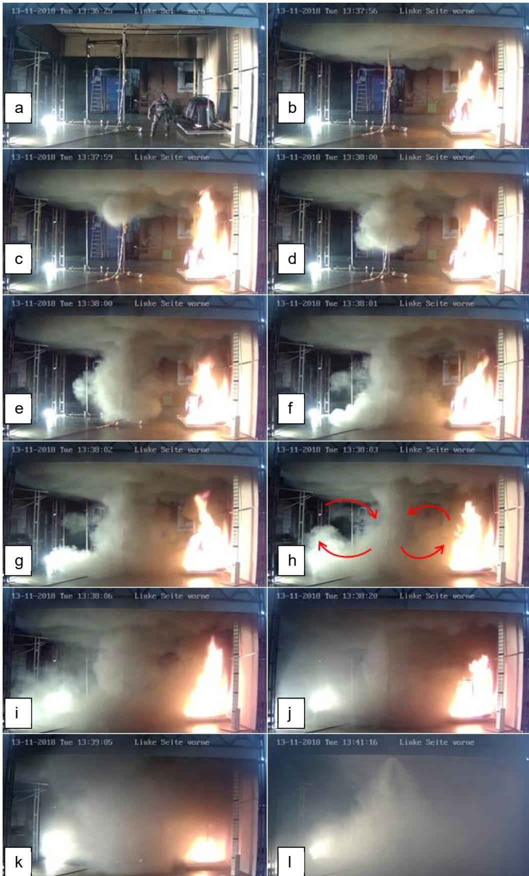
Abbildung 11: Versuchsverlauf für HDWN-Löschanlage (Zeiten: a-0s, b-90s, c-95s, d bis h-96 bis 98s, i-101s, j-115s, k/l-160 bis 291s)
