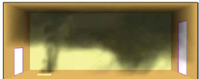
Abbildung 33: DES: Rauchverteilung nach der Sprinklerauslösung
