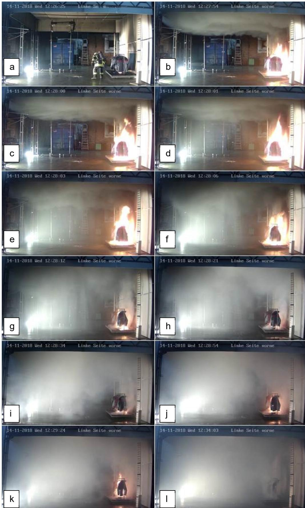
Abbildung 8: Versuchsverlauf für Standard-Sprinkler (Zeiten: a-0s, b-90s, c-95s, d bis f-97 bis 102s, g-107s, h/i-116 bis 130s, j/k-150 bis 350s, l-430s)
