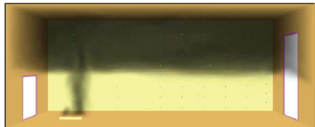
Abbildung 32: DES: Rauchverteilung vor der Sprinklerauslösung
