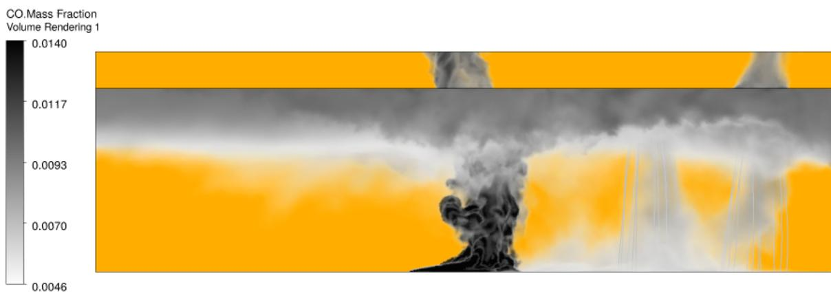
Abbildung 75: Rauchverteilung mit geöffneter NRA 1 (Brand), Sprinkler 1 und Sprinkler 2
