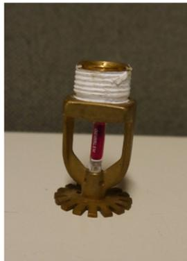
Abbildung 4: Standard-Sprinkler (EPK15) mit 5mm Glasfässchen (Auslösung bei 68 °C) [8]
