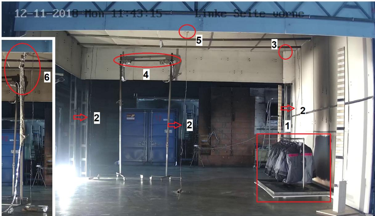
Abbildung 3: Versuchstand - Foto Seitenansicht (1-Probenkörper auf Waage, 2-drei TE-Bäume, 3-Abgassonde, 4-Extinktionsmessstrecke, 5-Sprinklerkopf bzw. 6-HDWN-Düse)
