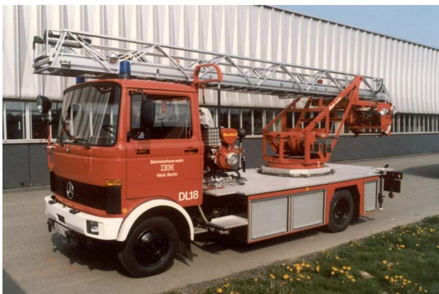
*Abb. 08, 1982: Die Anhängelleiter wurde nach einem Schaden durch eine Metz DL 18 hand auf MB-Fahrgestell LP 709 ersetzt*
