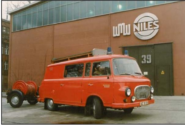
Linkes Foto das für kleinere betriebliche FFW (ehrenamtliche Kräfte) typische Kleinlöschfahrzeug KLF mit fahrbarer Schlauchhaspel. Dieses Fahrzeug aus DDR-Produktion hatte alle Geräte für eine komplette Gruppe 1:8 an Bord. Das Fahrzeug gehörte 1990 der betrieblichen FFW des VEB „Niles-Werke“ Berlin, einem Betrieb des Schwermaschinenbaus in der VVB WMW.
