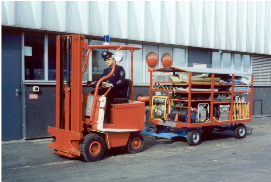
*Abb. 05, 1975: Der für diesen Zweck umgerüsteten Gabelstapler dient als "Zugmaschine" für den Anhänger mit einer kompletten Ausrüstung zur Ölschadensbekämpfung. Dieses „Gespann“ erlaubt auch den Einsatz innerhalb des Werkgebäudes (ca. 50.000 m<sup>2</sup>)*
