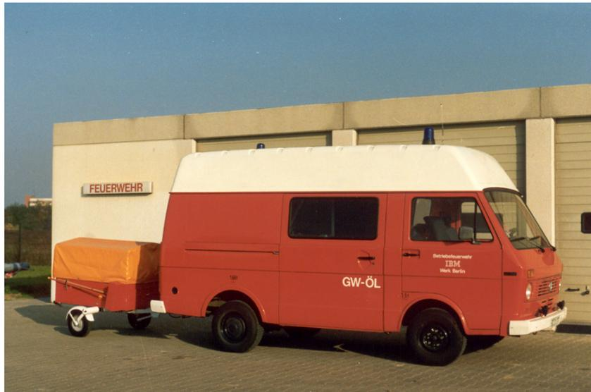
*Abb. 07, 1981: Ein VW LT 28 Kastenwagen, in Eigenleistung zum Gerätewagen-Öl ausgebaut, führte auf einem Einachsanhänger Ölbindemittel und Reinigungsgeräte mit*
