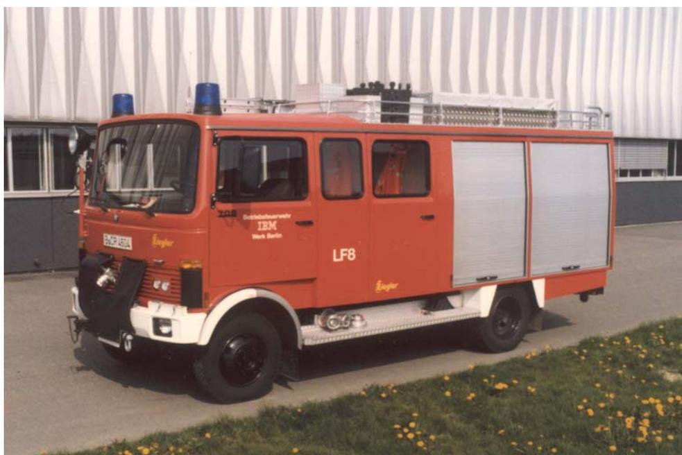
Abb. 10, 1985: Das neue Ziegler LF 8 nach Beladeplan 2, analog zur DL 18 auch auf Fahrgestell MB LP 708
