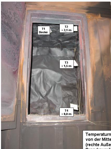
Bild A51: Temperaturmessstellen im Vorraumcontainer
