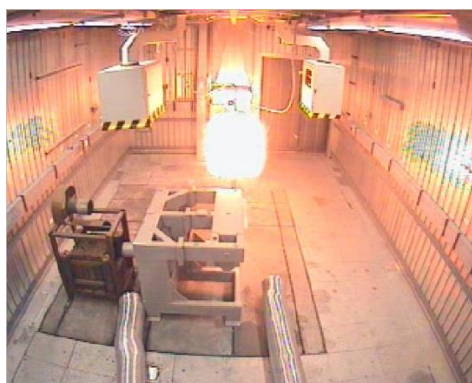
Abb 38. Links: Grosses Explosionsrohr zur Bestimmung von grundlegenden Stoffdaten; rechts: Detonationsexperiment in der grossen Testzelle TC160
