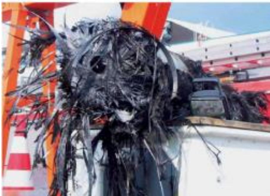
Abb. 18: Landeplatz des Druckbehälterfragments /36/
