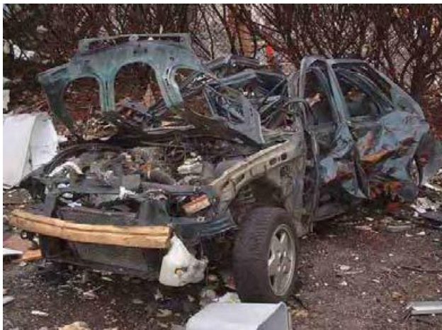
Abb. 13. Auswirkung einer Druckwelle mit einer Stärke von ca. 5bar auf einen PKW. /15/
