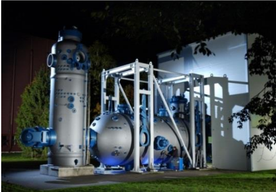
Abb. 37: Testbehälter H110 (horizontal 110m 3 ) und V60 (vertikal 60m 3 ) des Wasserstoffversuchszentrum HYKA
