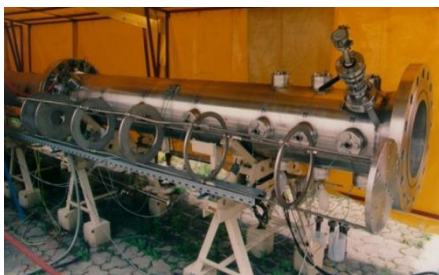
Abb 38. Links: Grosses Explosionsrohr zur Bestimmung von grundlegenden Stoffdaten; rechts: Detonationsexperiment in der grossen Testzelle TC160
