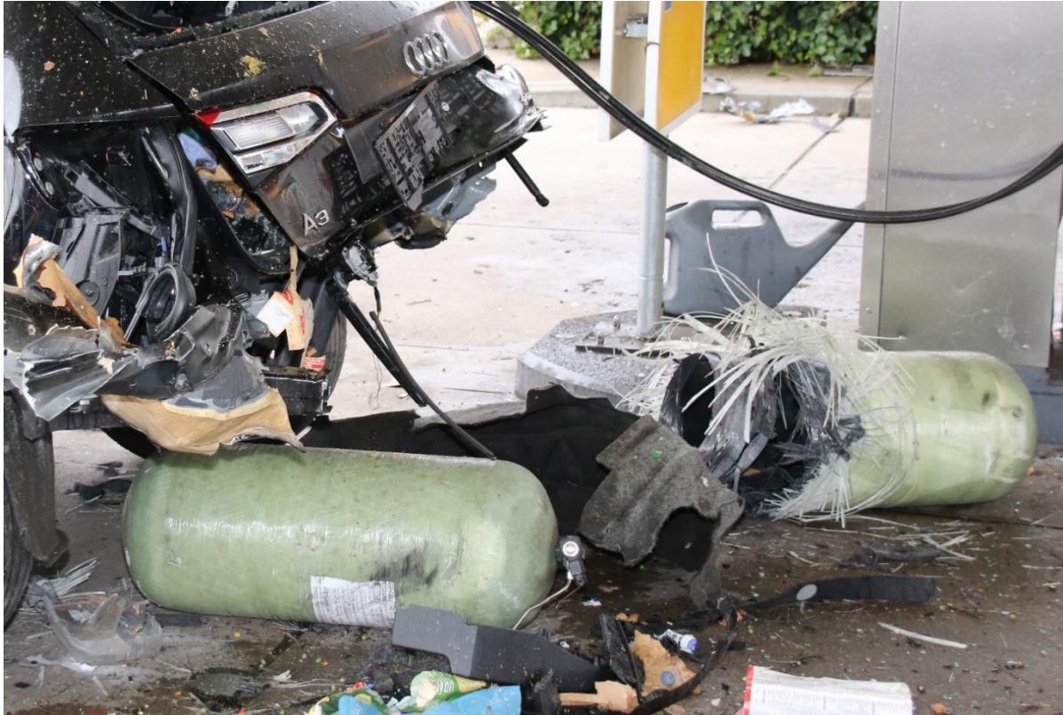
Abb. 19: Die beiden CNG-Tanks. Der Tank links im Bild blieb dicht. Bild mit freundlicher Genehmigung von Roland Spether /38/
