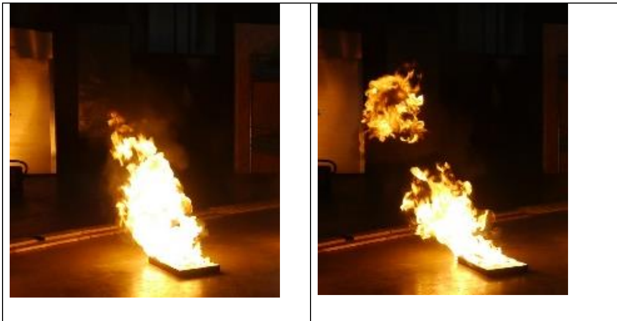
Abb. 2: Zwei Aufnahmen eines Benzin-Lachenbrandes im zeitlichen Abstand von 1s. Rechts ist eine abgelöste Flamme zu sehen. Dort verbrennt hauptsächlich noch CO, aber nicht vollständig, obwohl Luftüberschuss vorhanden ist. Die Flammenfront ist nicht eben und ortsfest wie bei der Kerze, sondern unregelmäßig. Quelle: /7/
