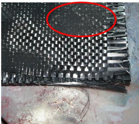
*Abbildung 7 Kohlenstofffasergewebe (nach dem Versuch); Verkohlungsreste (roter Rahmen)*
