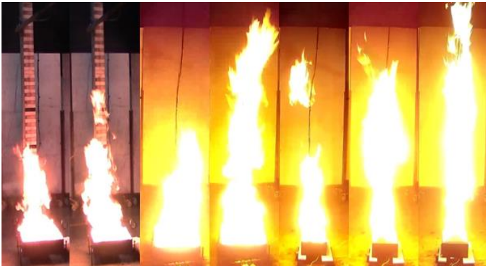
Abbildung 9 Momentaufnahme freie Flamme mit unterschiedlichen Brennern und Wärmefreisetzungsraten
