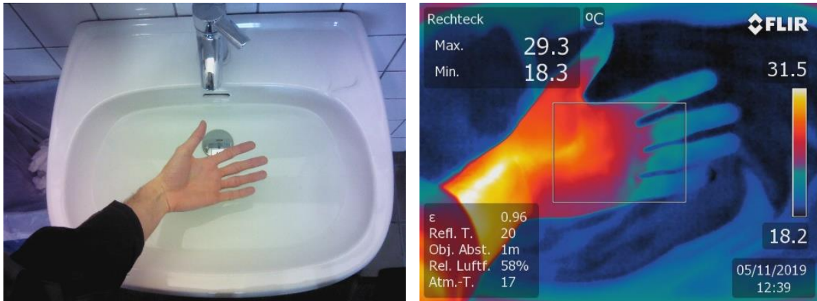
Abb. 5: Hand oberhalb der kalten Wasseroberfläche. Links herkömmliche Aufnahme mit Digitalkamera, rechts Aufnahme mit der WBK
