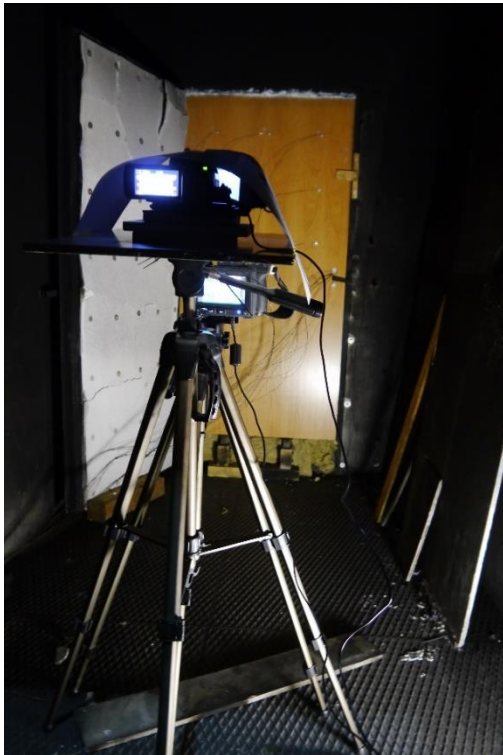
Abb. 27: Versuchsaufbau Wärmebildkamas vor Türaußenseite
