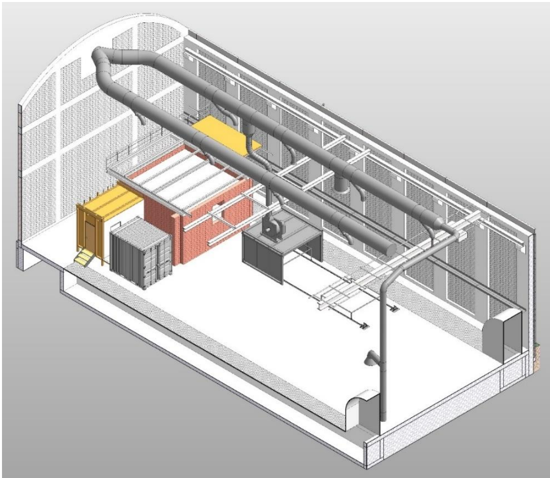
Abb. 21: „Wohnzimmer“ (rot) und Vorraum (gelb mit Treppe) in der Versuchshalle
