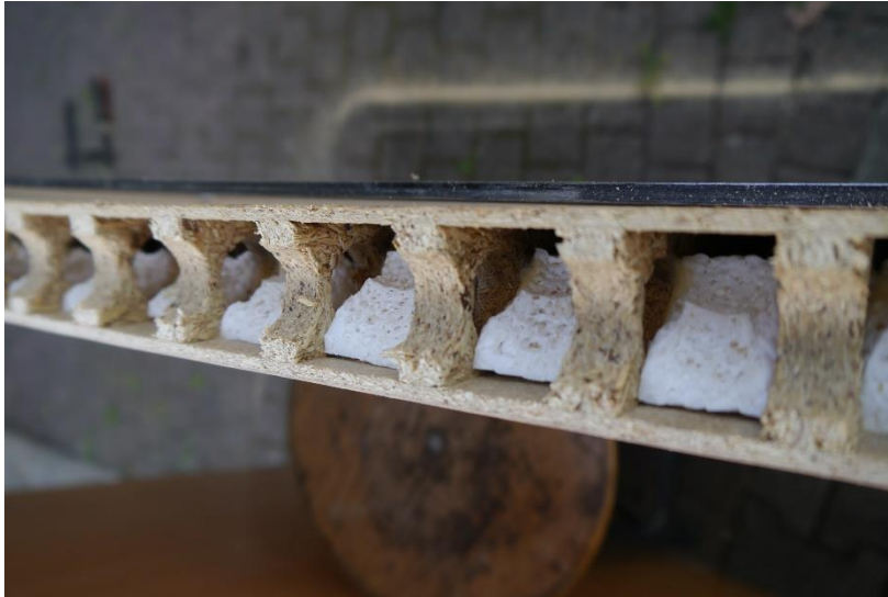
Abb. 19: Schnitt der verwendeten Innentür aus Buchenholz (1985x985x40 mm, 35 kg)
