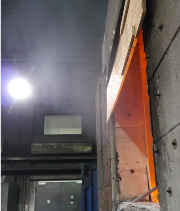
Abb. 26: Rauchaustritt aus Versuchsraum durch teilweise verdeckte Fensteröffnung
