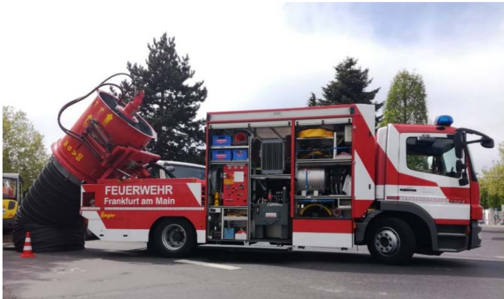
Abb. 2: Mobiler Großventilator der Branddirektion Frankfurt am Main im nach hinten abgekippten Betriebszustand mit angeschlossener Lutte
