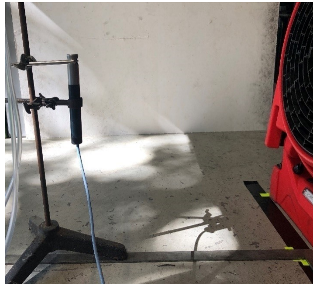
Abb. 13: Versuchsaufbau Bestimmung Strömungsgeschwindigkeit
