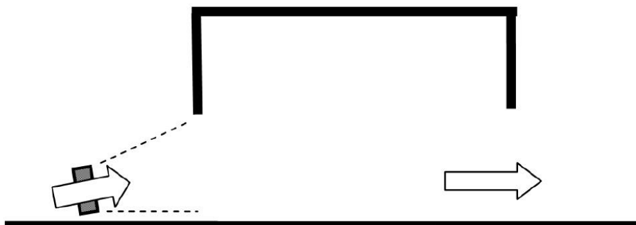
Abb. 7: Überdrucklüfter mit hoher Strahlaufweitung (Reick, 2015)
