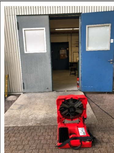
Abb. 35: Akkulüfter im Abstand von 2m vor vollflächig geöffneter Zuluftöffnung
