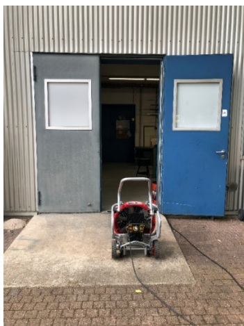
Abb. 38: 230V-Lüfter vor vollflächig geöffneter Zuluftöffnung
