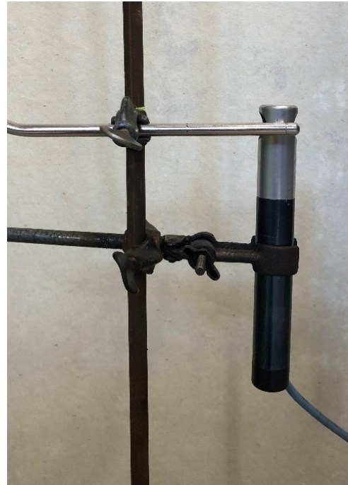
Abb. 11: Seitenansicht Messstelle Strömungsgeschwindigkeit
