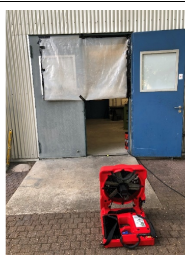
Abb. 36: Akkulüfter im Abstand von 2m vor halb verschlossener Zuluftöffnung
