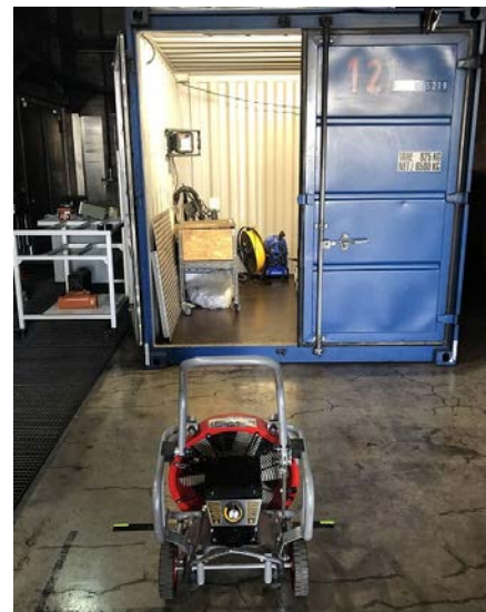
Abb. 26: Positionierung Lüfter vor Container für Druckmessung
