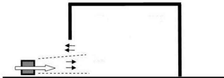
Abb. 30: Gegengerichtete Strömung an der Tür (Reick, 2015)
