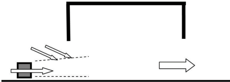
Abb. 6: Injektorlüfter mit geringer Strahlaufweitung (Reick, 2015)
