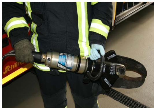
Abbildung 13: Beispiel für eine Rettungsschere [Kullik, D. /2017-3/]
