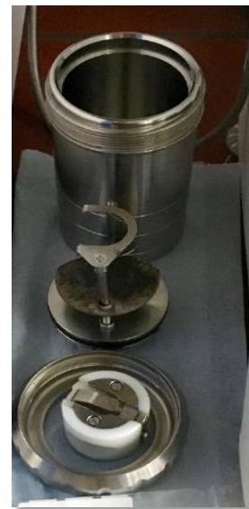
Abbildung 20 Kalorimeterbombe, Zündvorrichtung, Behälter, Dichtung
