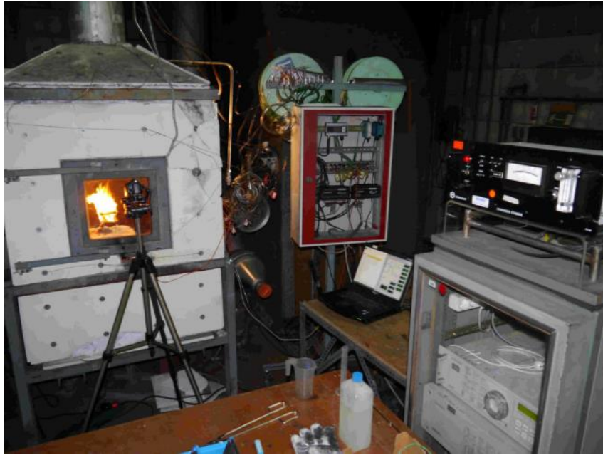
Abbildung 22 Messkammer nach Vorbild DIN EN 13823
