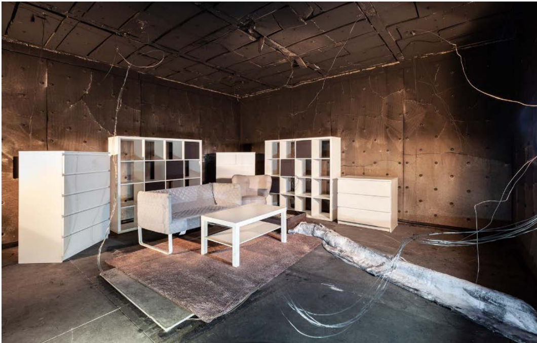
Abbildung 18 Möblierter Brandraum vor der Zündung
