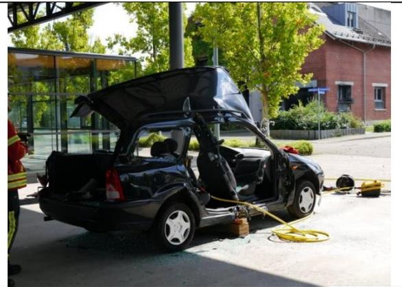
*Abbildung 43:* Arbeiten mit dem Rettungszyylinder - Versuchsfahrzeug 2
