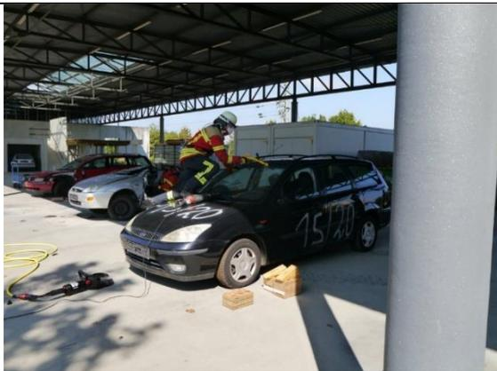
Abbildung 36: Arbeiten mit dem Glas-Master - Versuchsfahrzeug 2
