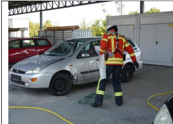
Abbildung 21: Übungspuppe mit Staub- und Fasermesstechnik, Abdecken mit Patientenschutzfolie, Versuchsfahrzeug 1
