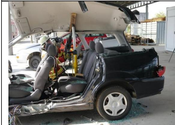
*Abbildung 44:* Arbeiten mit dem Rettungszyylinder - Versuchsfahrzeug 2
