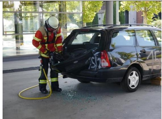
*Abbildung 39: Arbeiten mit dem hydraulischen Spreizer - Versuchsfahrzeug 2*
