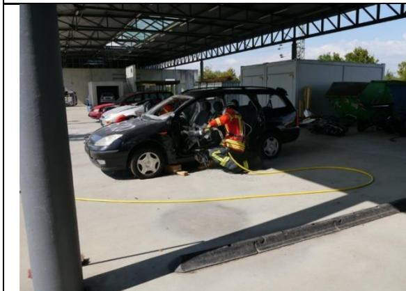
*Abbildung 40: Arbeiten mit dem hydraulischen Spreizer - Versuchsfahrzeug 2*
