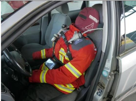
*Abbildung 19: Übungspuppe mit Staub- und Fasermesstechnik vor dem Abdecken mit Patientenschutzfolie, Versuchsfahrzeug 1 - Vorderseite*
