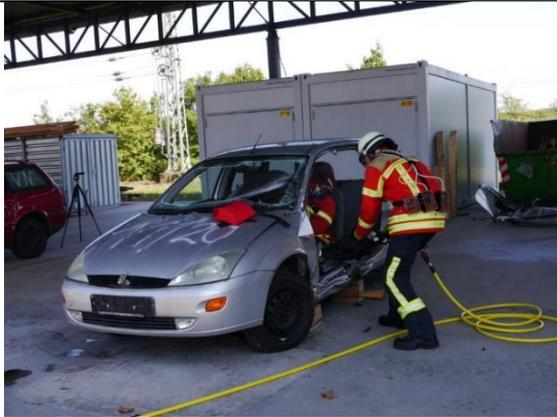
*Abbildung 25: Arbeiten mit dem hydraulischen Spreizer - Versuchsfahrzeug 1*
