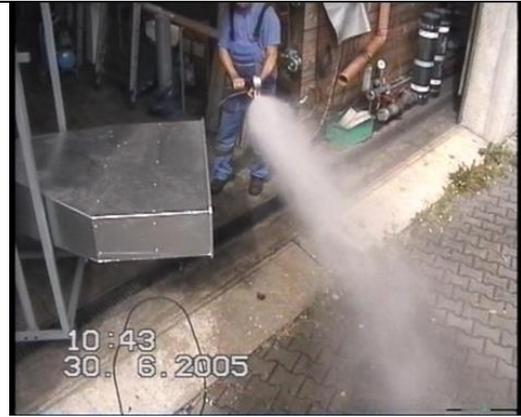
Abbildung 2: Kaltsprühversuch mit Hochdruck-Wassernebel - Einzeldüse – 135 bar
