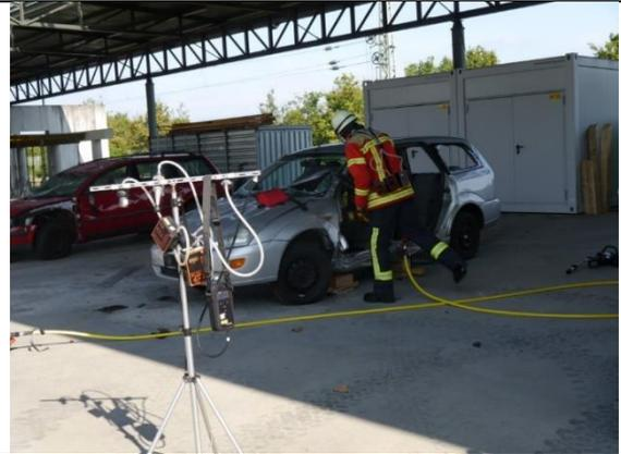
*Abbildung 26: Arbeiten mit der hydraulischen Rettungsschere - Versuchsfahrzeug 1*
