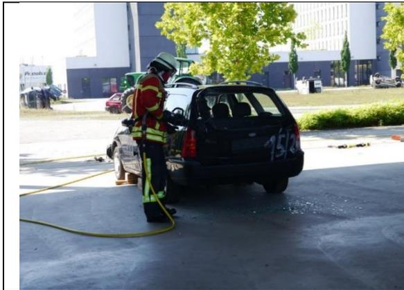
*Abbildung 38: Arbeiten mit dem hydraulischen Spreizer - Versuchsfahrzeug 2*
