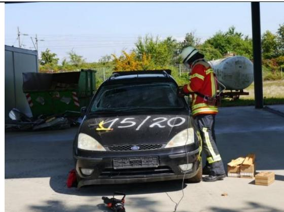
Abbildung 37: Arbeiten mit der Säbelsäge - Versuchsfahrzeug 2
