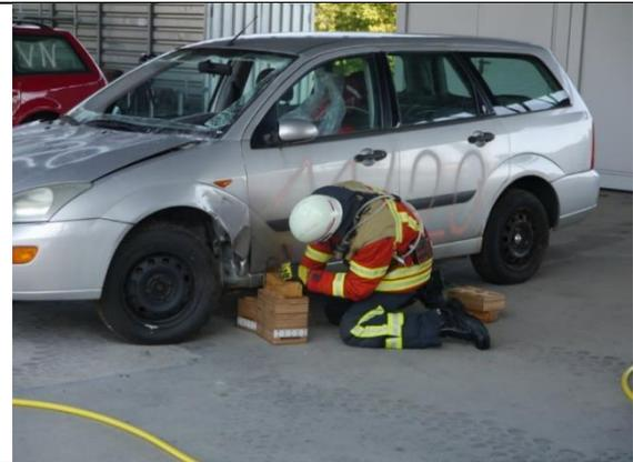
Abbildung 24: Stabilisierung des Unfallfahrzeuges - Versuchsfahrzeug 1
