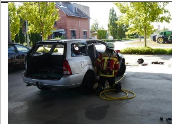
*Abbildung 31: Arbeiten mit dem Rettungszylinder - Versuchsfahrzeug 1*
