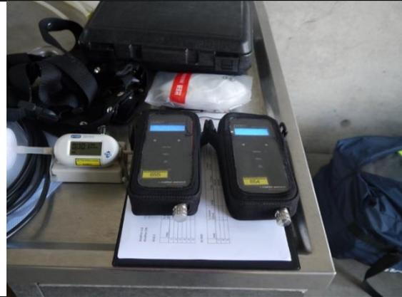
*Abbildung 7:* Staub- und Fasermess-technik - 2 (DGUV-IFA, UK NRW)
