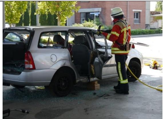
*Abbildung 28: Arbeiten mit der Säbelsäge - Versuchsfahrzeug 1*
