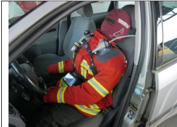
Abbildung 8: Dummy - Übungspuppe als Patient mit Staub- und Fasermesstechnik vor dem Abdecken mit Patientenschutzfolie, Versuchsfahrzeug 1 - Vorderseite
