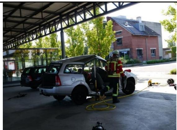
*Abbildung 32: Arbeiten mit dem Rettungszylinder - Versuchsfahrzeug 1*
