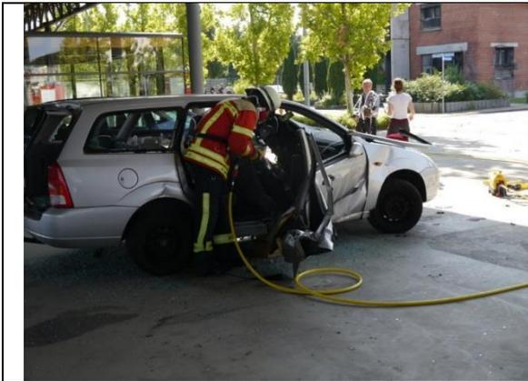
*Abbildung 29: Arbeiten mit dem hydraulischen Spreizer - Versuchsfahrzeug 1*
