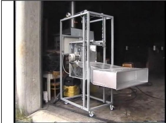
Abbildung 1: Radialgebläse zur Winderzeugung: 3 m/s [Kunkelmann, J. /2007/]
