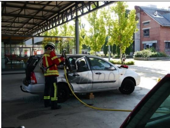
*Abbildung 27: Arbeiten mit dem hydraulischen Spreizer - Versuchsfahrzeug 1*
