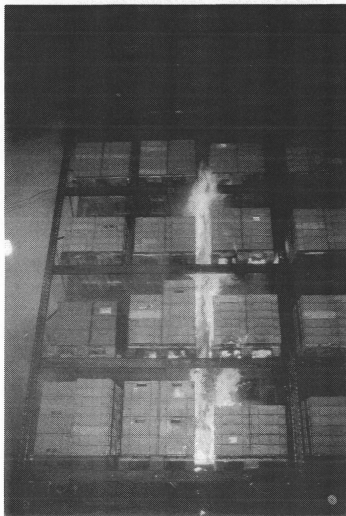
Bild 46: Brandverlauf nach einer Versuchszeit von 2 min 43 s.
