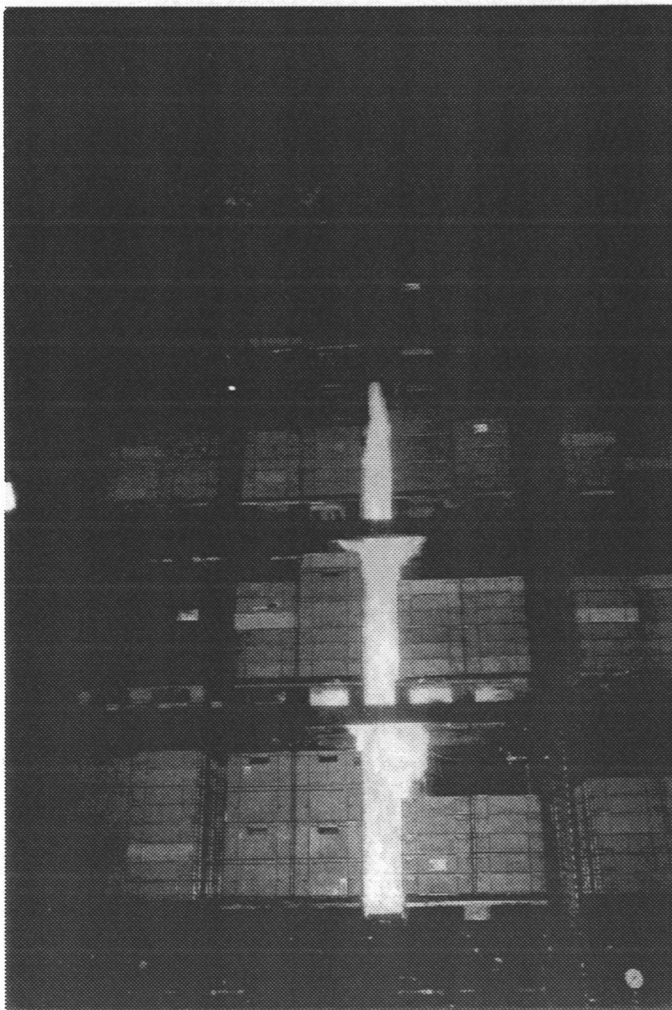
Bild 44: Brandverlauf nach einer Versuchszeit von 1 min 20 s.
