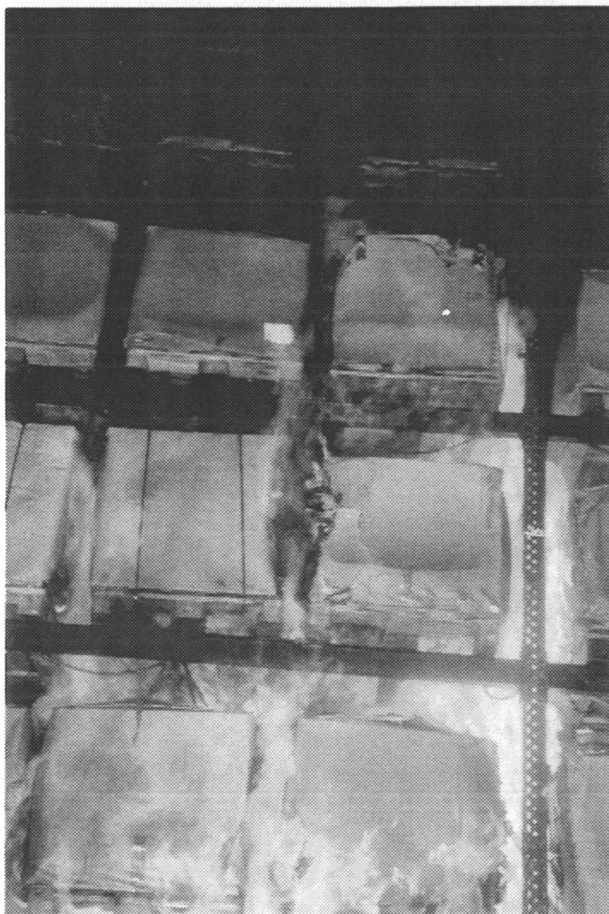
Bild 34: Brandverlauf nach einer Versuchszeit von 54 s (2. bis 5. Regalebene).
