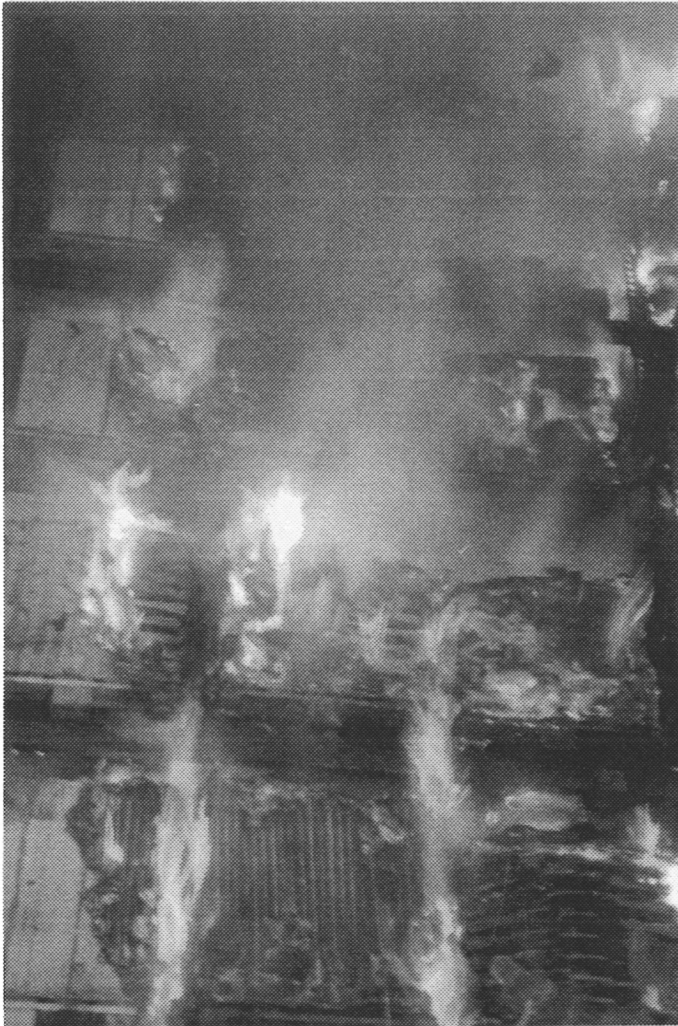
Bild 35: Brandverlauf nach einer Versuchszeit von 2 min 2 s (3. bis 7. Regalebene).
