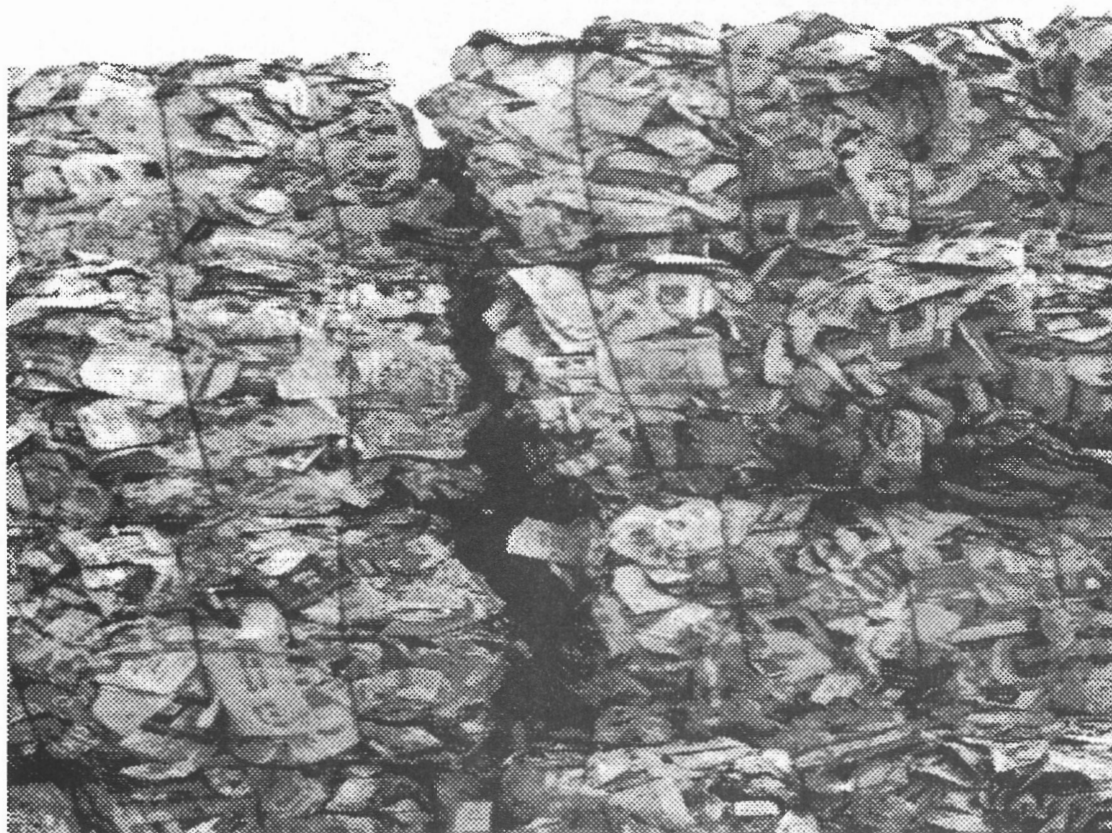
Abbildung 5.1.2 Technologisch bedingte Zwischenräume bei der Lagerung
