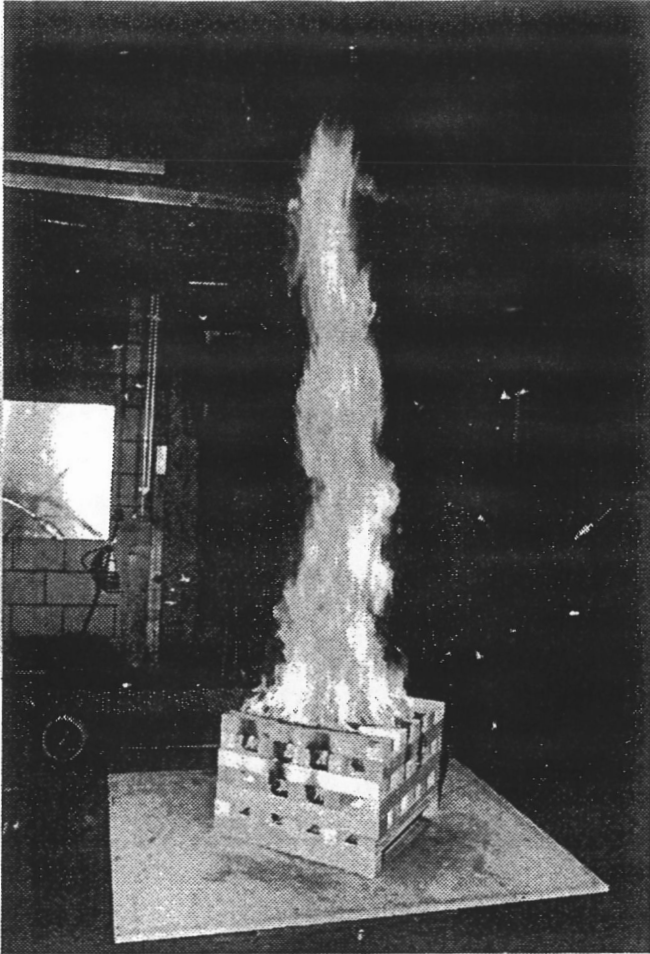
Bild 11a. Brandausbreitung HK3, Versuchszeit 5 min.
