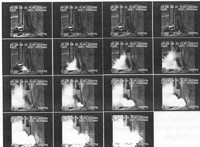
**Abbildung 17: Hochgeschwindigkeitsaufnahme eines Berstversuches mit einer vollen Sprayflasche**
