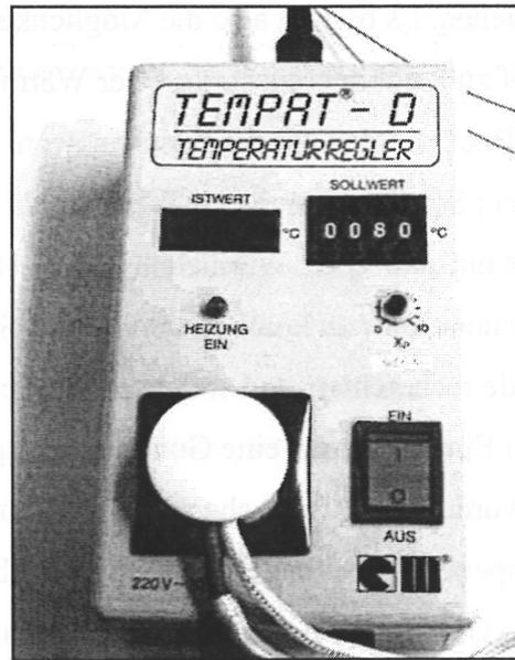
Bild 4.77: Temperaturregler Tempat<sup>®</sup>-D
