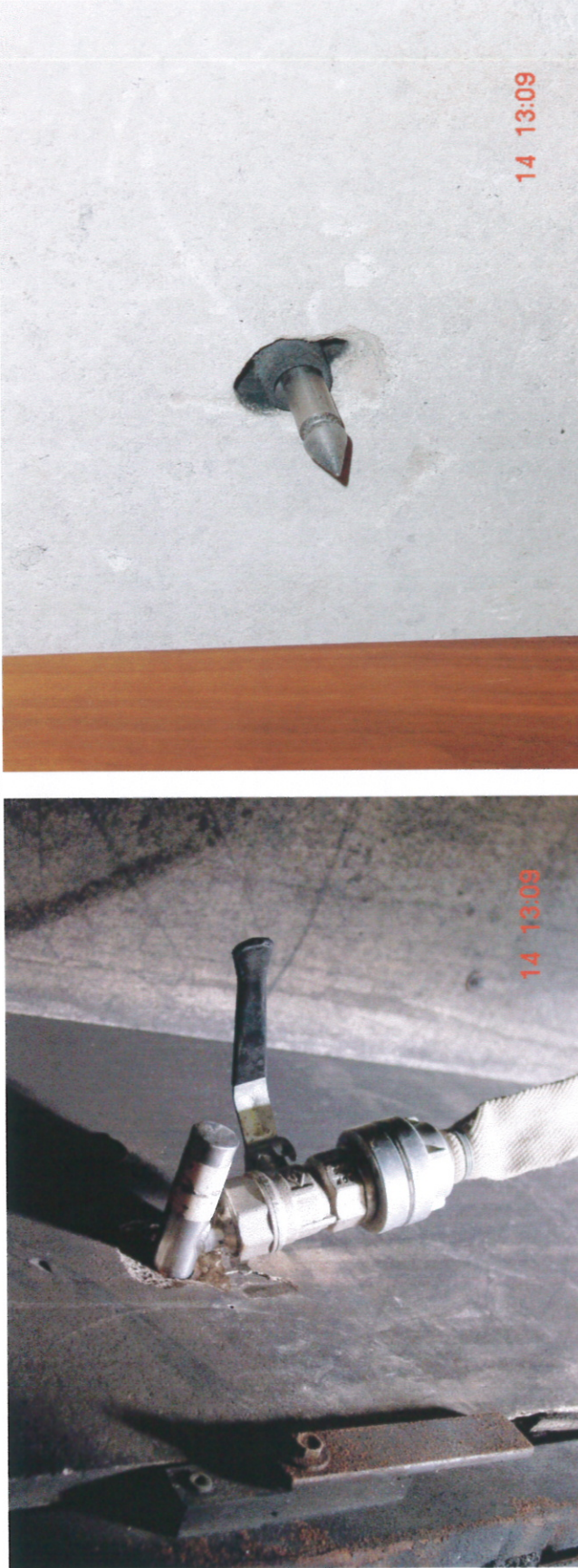
Bild 8.1: Wirkungsweise des Fog Nails (1).
