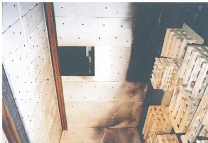
Bild 4.1.1: Beispiel 1 eines Brandversuches mit Flashover an der FfB. Thermische Belastung von Stahlträgern - Versuchsaufbau und Brandlast.
