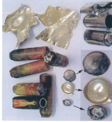
Schadensbilder bei den Druckgaspackungen
