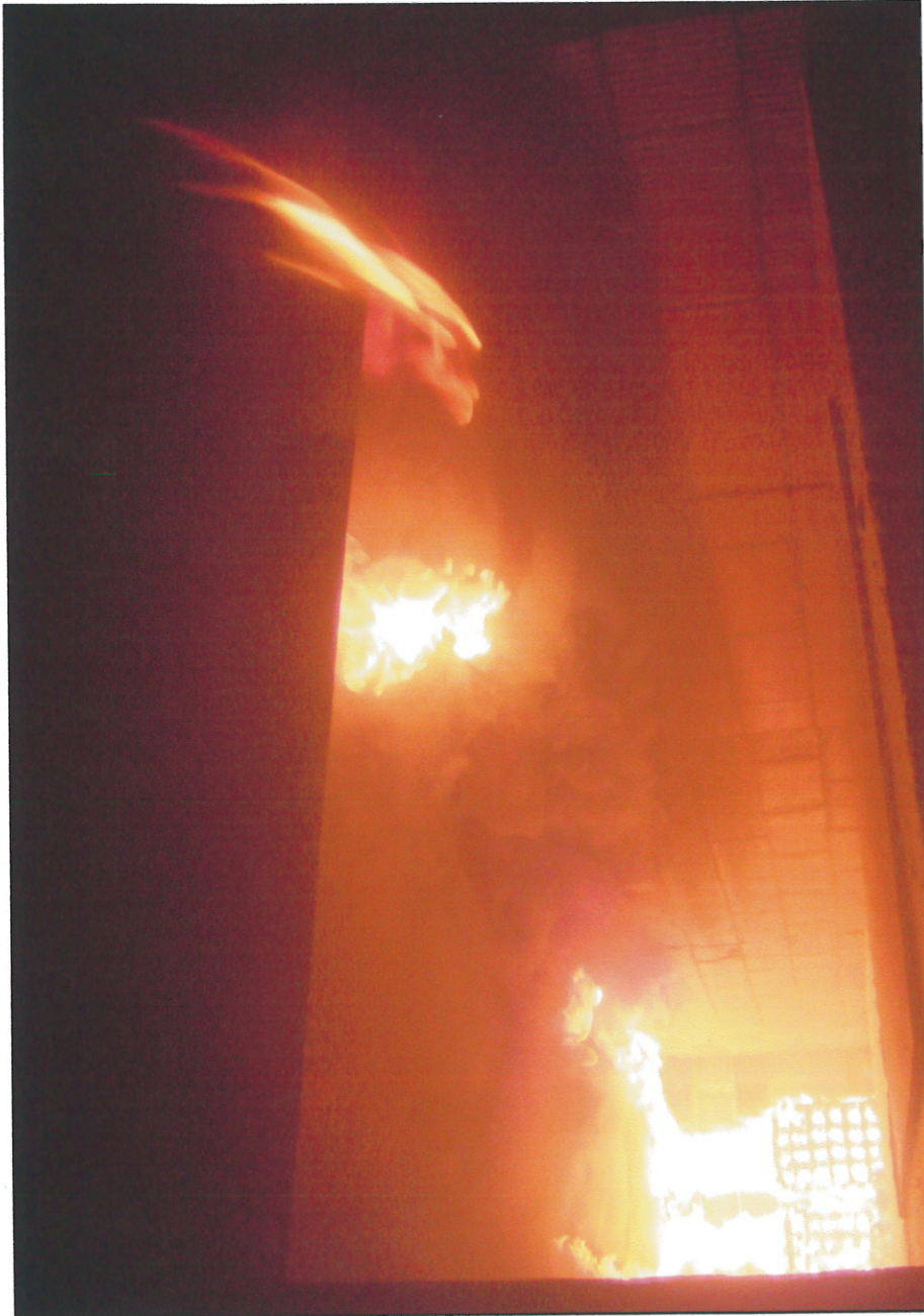
Rollover während eines Brandversuches an einem Industrieleichtdach
