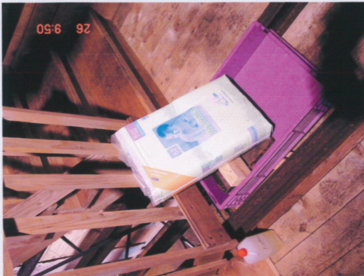
3.82 Stapelbehälter aus Polypropylen (ca. 2 kg), 1 Paket Babywindeln (ca. 2,8 kg), 2 Vierkanthölzer (ca. 0,8 kg), Zündwanne (300 mm * 200 mm * 40 mm mit Heptan (0,5 l)
