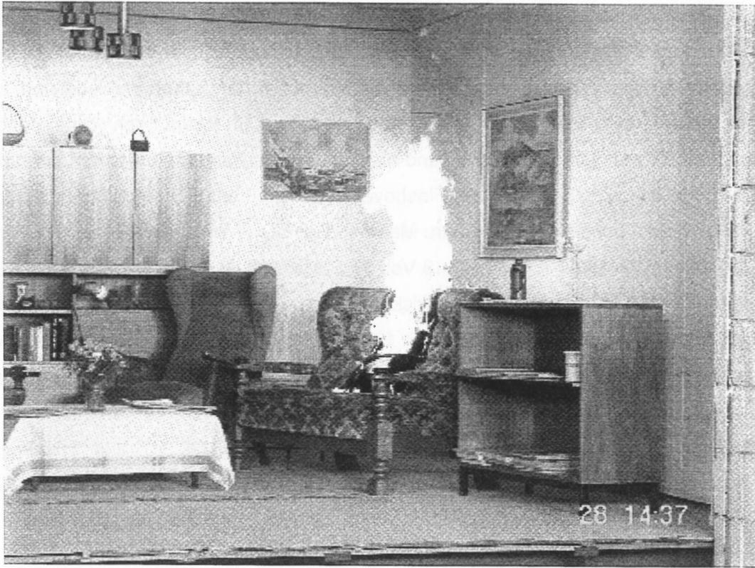
Bild 11.2: Flammenszenario 7 min nach der Zündung
