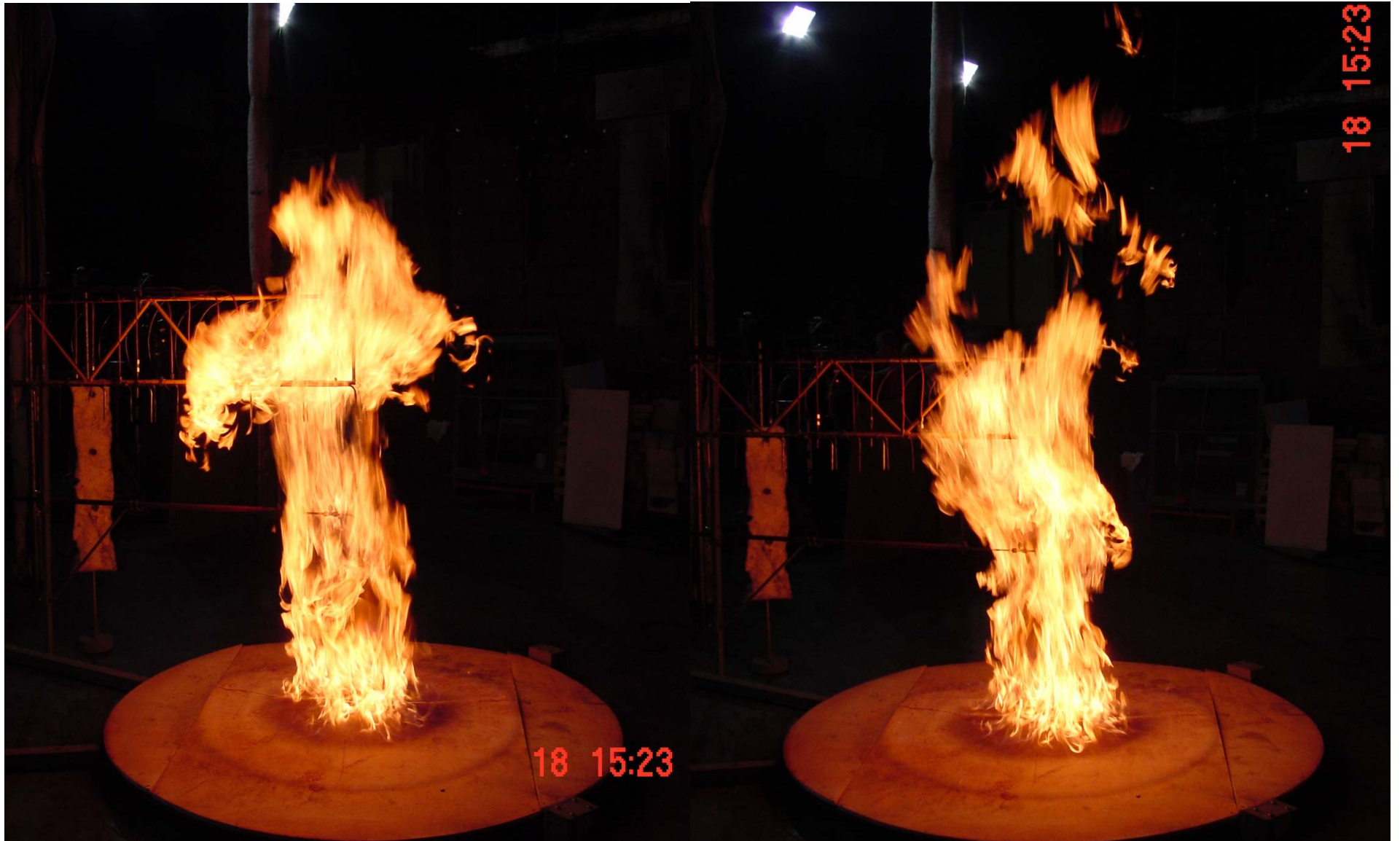
Bild 9a. Sprühdüsenbrenner (D3), 500 kW Flamme (Zeitpunkt a). Bild 9b. Sprühdüsenbrenner (D3), 500 kW Flamme (Zeitpunkt b).
