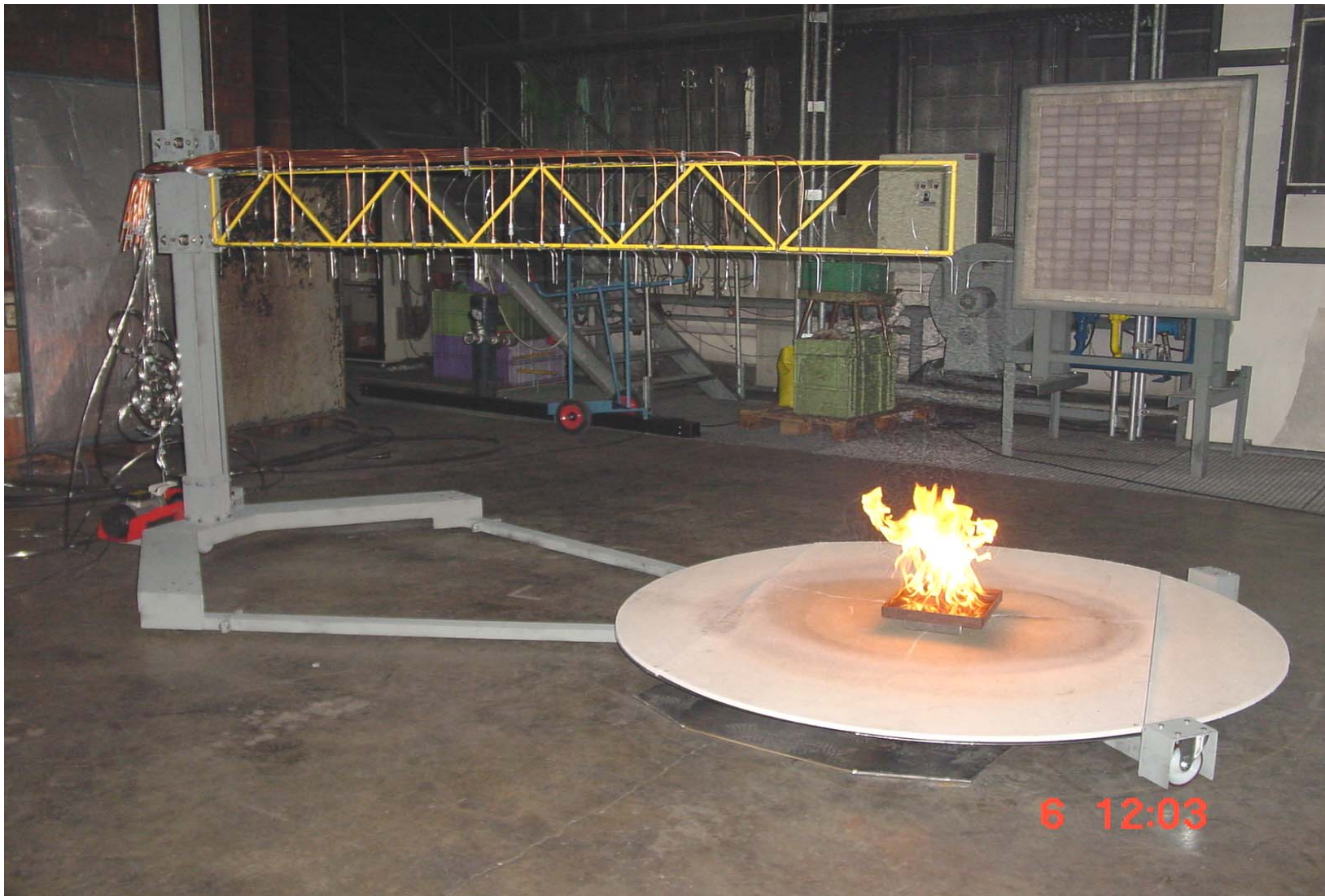
Bild 8. Koordinatengerät zur Bestimmung von Temperatur- und Strömungsfeldern auftriebsbehafteter Flammen mit Testbrand auf der Bodenplatte.
