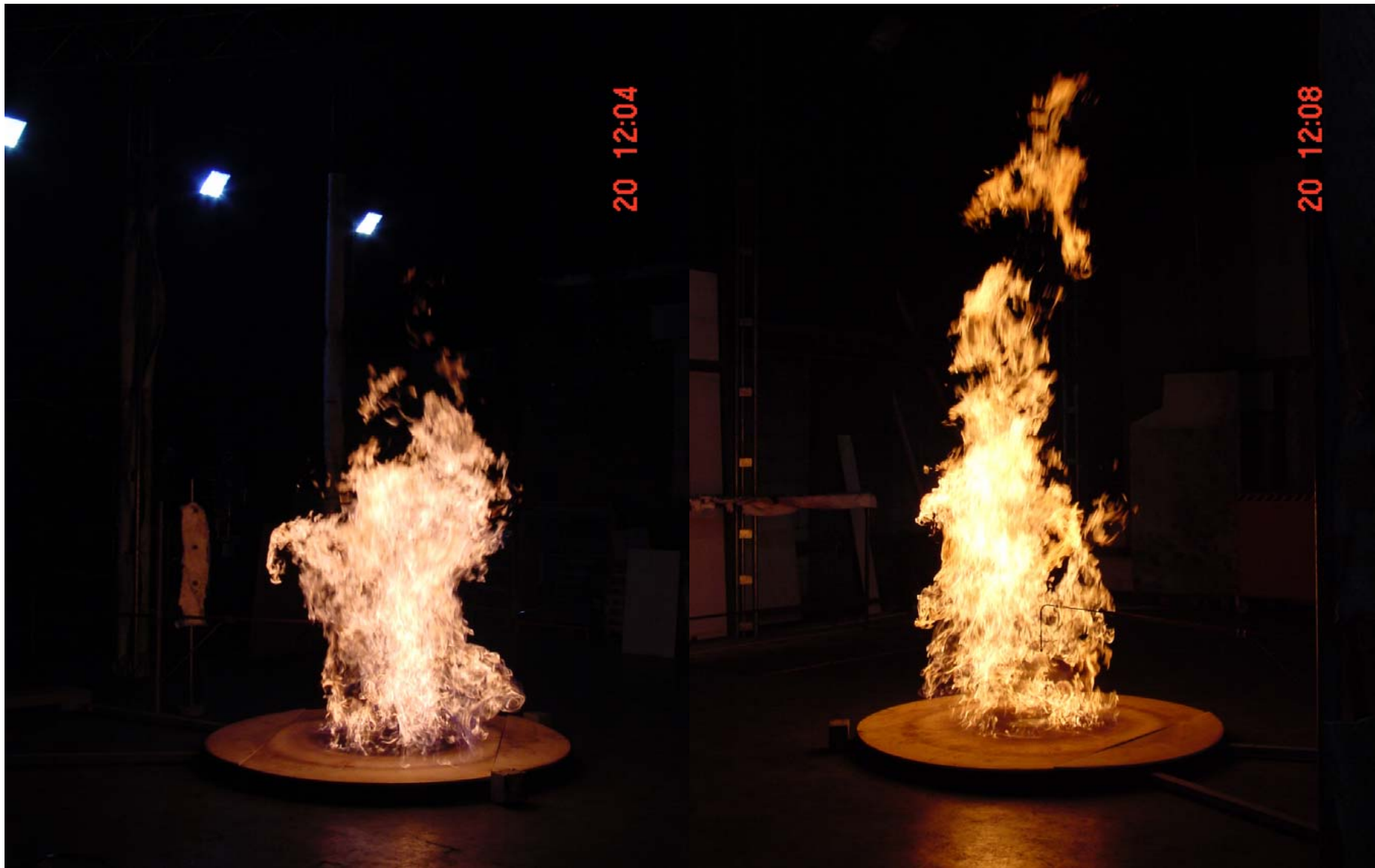
Bild 13a. Sprühdüsenbrenner (D5), 1200 kW Flamme (Zeitpunkt a).
