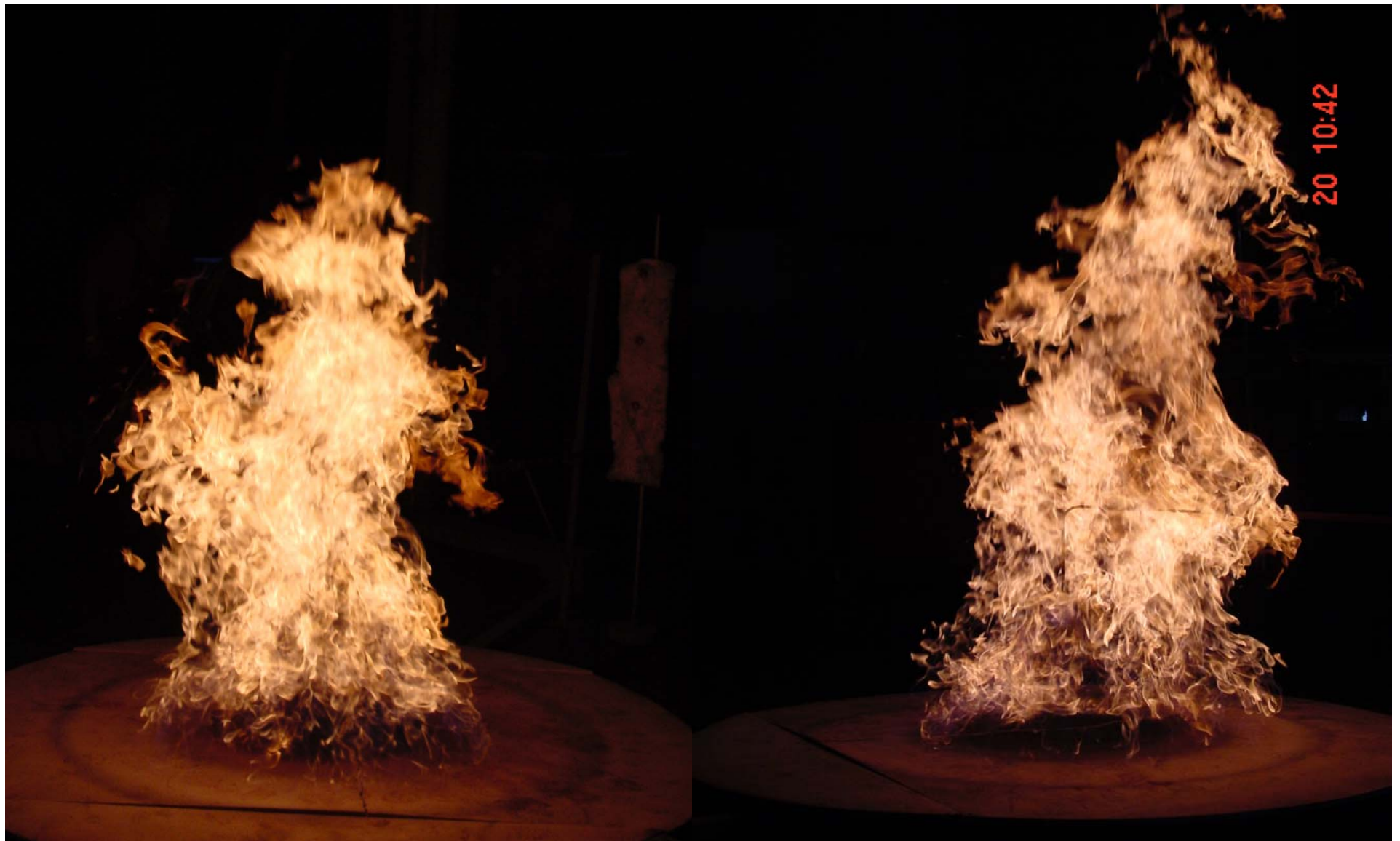
Bild 12a. Sprühdüsenbrenner (D5),1200 kW Flamme (Zeitpunkt a). Bild 12b. Sprühdüsenbrenner (D5),1200 kW Flamme (Zeitpunkt b)
