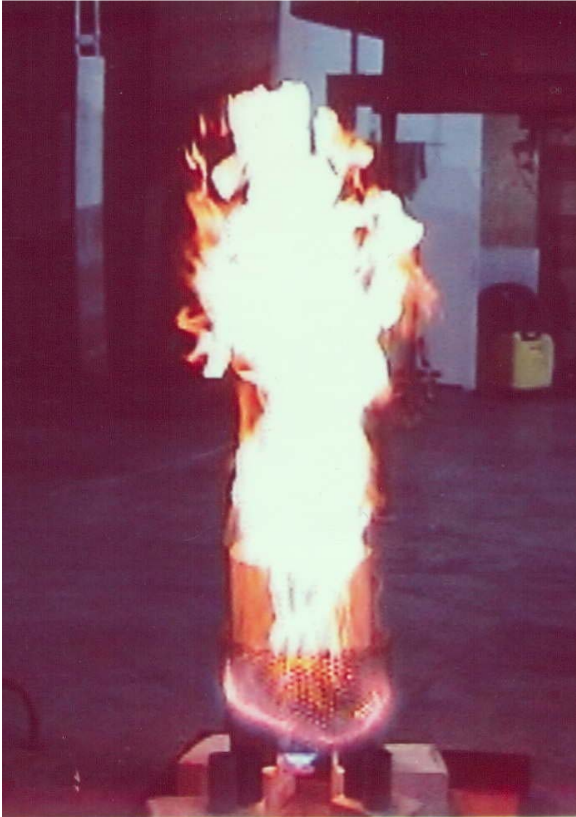
Bild 5. Anordnung eines nach oben gerichteten Test-Sprühbrenners mit Auffangvorrichtung aus Lochblech und Maschendraht.
