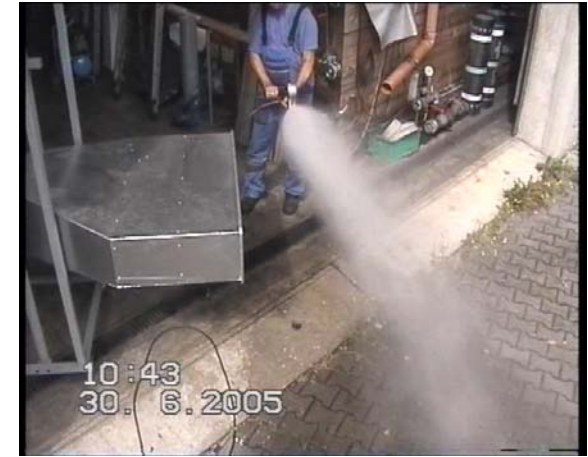
Einzeldüse – 135 bar Ablenkung durch Radialgebläse (3 m/s)
