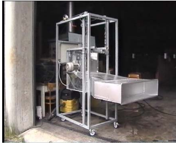
Radialgebläse zur Winderzeugung Windgeschwindigkeit: 3 m/s
