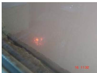
Bild 7.3: Versuch HDSC135B4 – Brandentwicklung u. Verrauchung bei der Auslösung von Rauchmeldern u. Indikatorsprinklern
