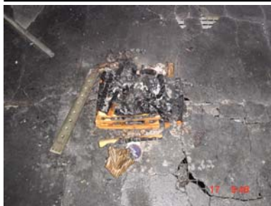
Bild 8.2: Versuch HDSC135B5 – Brandentwicklung u. Verrauchung bei der Auslösung von Rauchmeldern u. Indikatorsprinklern
