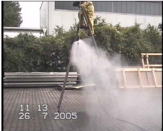
Sprühkopf mit 4 Düsen – 135 bar Ablenkung durch Wind im Freien Windgeschwindigkeit: 3,2 m/s
