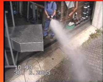
Einzeldüse – 135 bar Ablenkung durch Wind (3 m/s)
