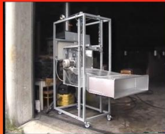
Radialgebläse zur Winderzeugung Windgeschwindigkeit: 3 m/s
