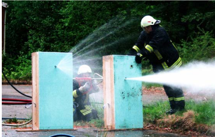
Bild 6-4 CCS Cobra® Schneid-/Löschsystem und Fognail® im Vergleich
