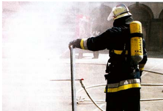
Bild 6-2 Feuerwehrmann mit Fognail® (Feuerwehr Karlsruhe)
