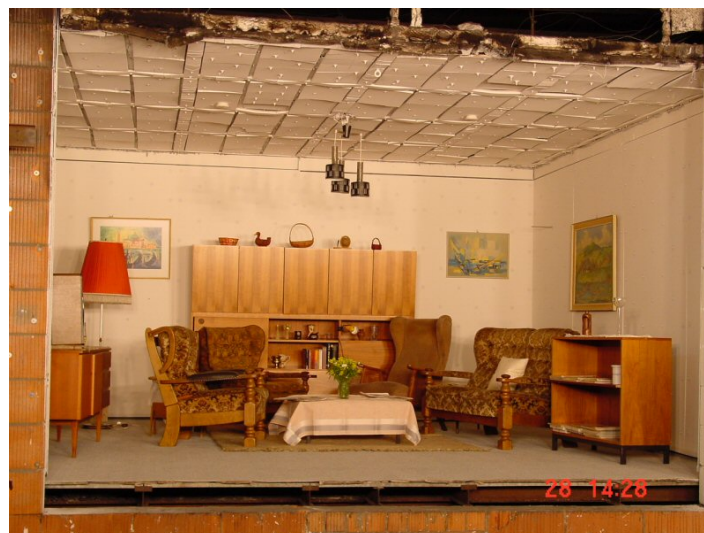
Bild 5-2 Brandraum vor der Zündung [FFB]
