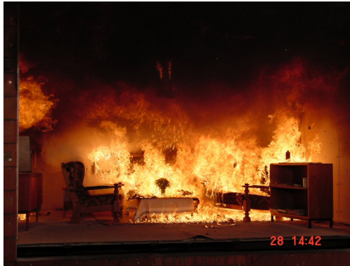
Bild 5-5 Brandraum nach erfolgreichem Flashover [FFB]
