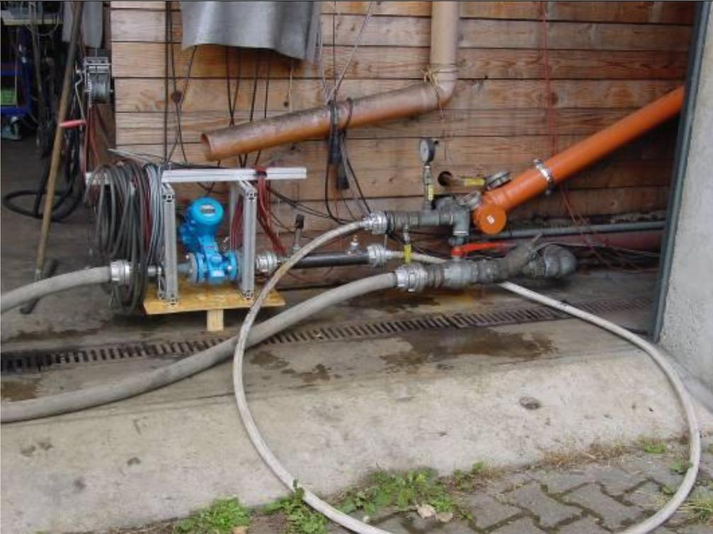
Abbildung 24: Löschwasserversorgung (Niederdruck) über Kreiselpumpe (nicht im Bild) zum Versuchslabor mit magnetisch induktivem Durchflussmesser (blau) und nachgeschaltetem piezoresistiven Druckmessumformer.
