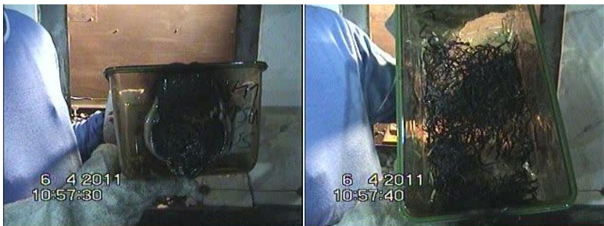
Abbildung 46: PPSU-Käfigschale im Innenbereich mit Weizenstroh nach Brandbeaufschlagung (V11).
