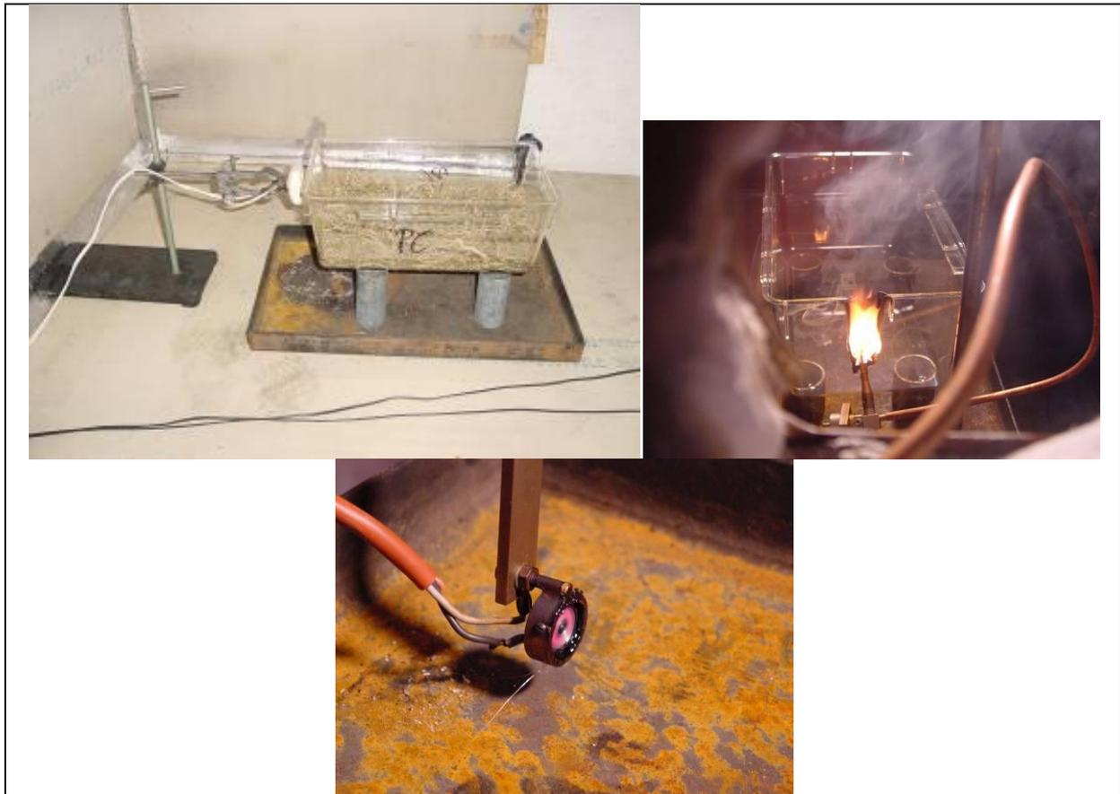
*Abbildung 16:* Brandlast: Käfigschale aus Polycarbonat (PC) mit Tierstreu, Wärmestrahler (Keramikstrahler als Zündquelle (linke Seite der Käfigschale), Bild oben), Weitere Zündquellen: Propankleinbrenner (Bild links unten) und PKW-Zigarettenanzünder (Bild rechts unten).
