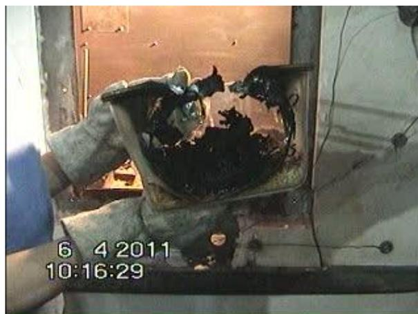
Abbildung 43: PSU-Käfigschale im Frontbereich nach Brandbeaufschlagung (V10).
