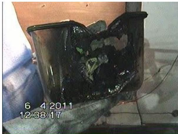
Abbildung 53: PSU-Käfigschale im Frontbereich mit Weizenstroh nach Brandbeaufschlagung (V14).
