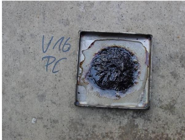
Abbildung 36: PC-Probekörper nach Versuchsende (V16).
