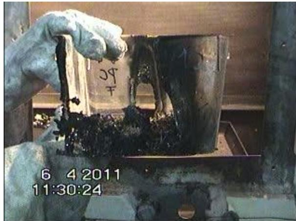
Abbildung 48: PC-Käfigschale im Frontbereich mit Wiesenheu nach Brandbeaufschlagung.
