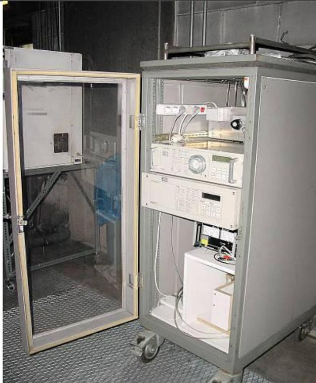
*Abbildung 30:* Messung der Kohlenstoffdioxid-, Kohlenstoffmonoxid- und Sauerstoffkonzentration im Versuchslabor mit kontinuierlich messenden Gasanalysatoren.
