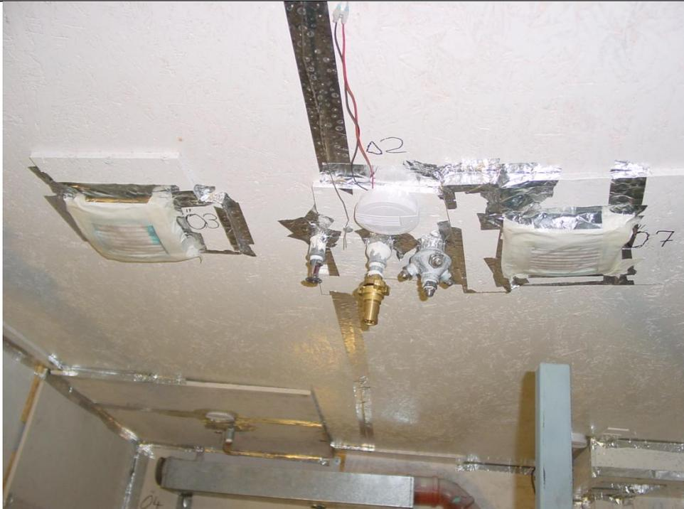
Abbildung 12: Versuchslabor – Decke zentral: Lüftungsöffnungen (2 Stück), Niederdruck- Wasserebeldüse (Bild Mitte) und Hochdruck- Wasserebelsprühkopf (Bild rechts), Indicatorsprinkler (Bild links), Rauchmelder (Bild vorne Mitte).
