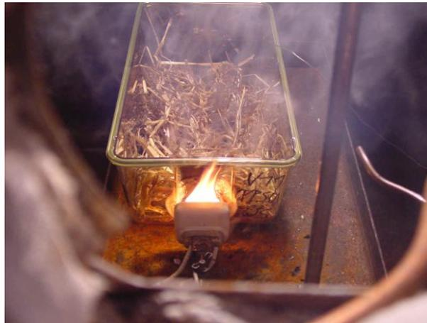
Abbildung 45: PPSU-Käfigschale im Frontbereich mit Weizenstroh bei Beaufschlagung mit Wärmestrahler (V11).
