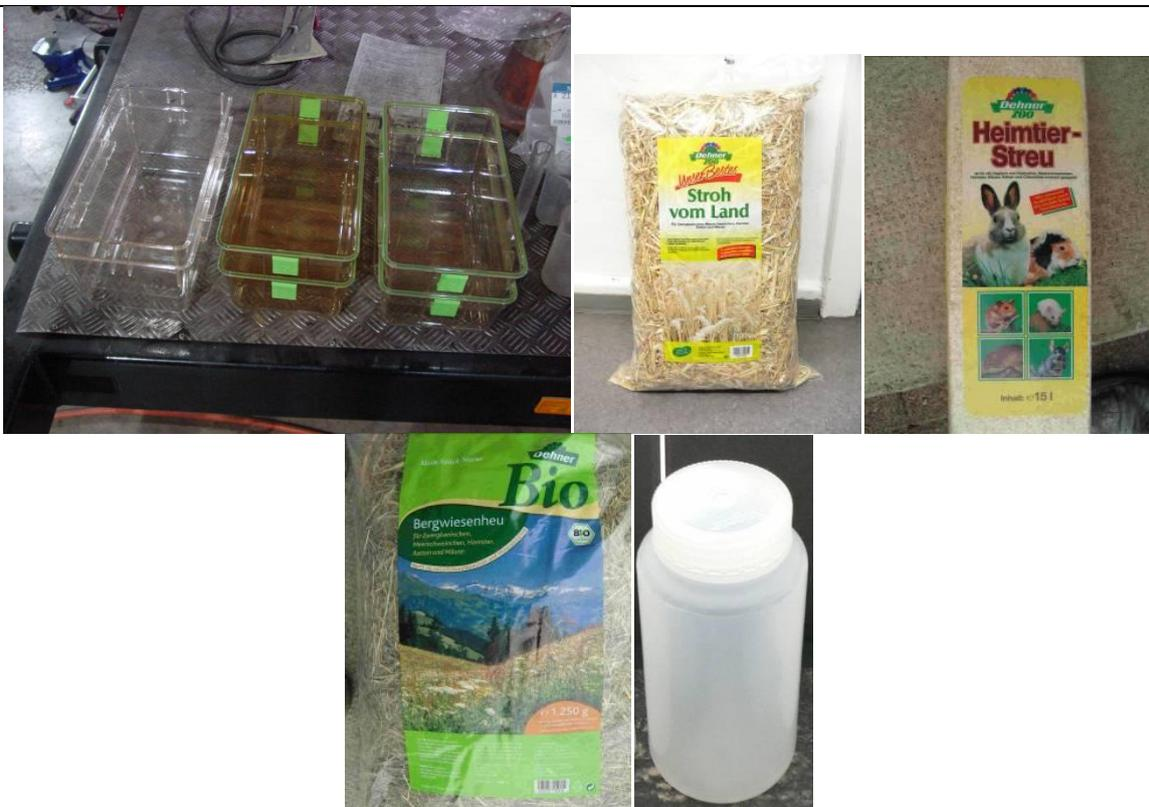
Abbildung 15: Brandlasten: Käfigschalen für Mäuse (Bild links oben: links: Polycarbonat (PC), Mitte: Polyphenylsulfon (PPSU), rechts: Polysulfon (PSU), verschiedene Einstreumaterialien, PP-Behälter.
