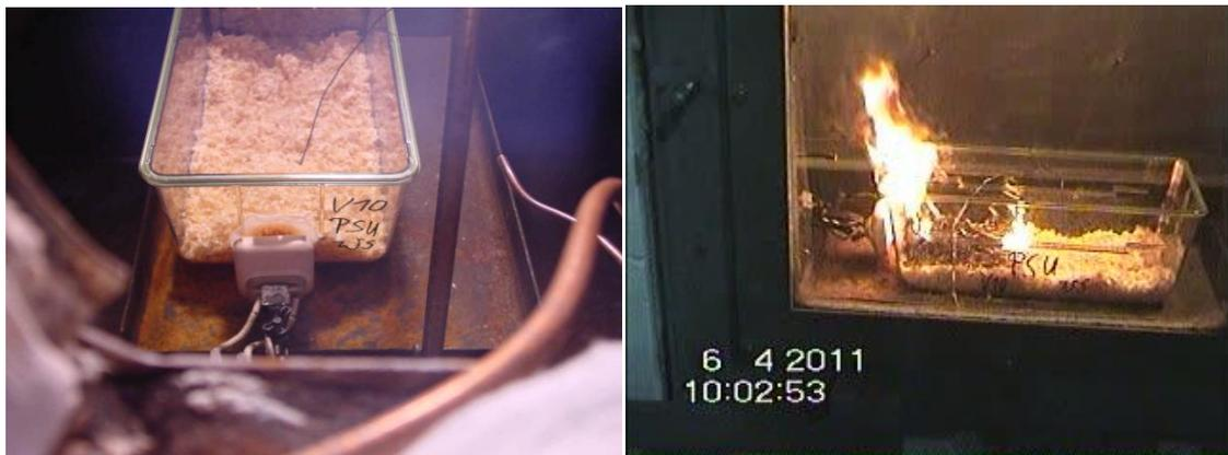
Abbildung 42: Brandverlauf der PSU – Käfigschale mit Holzspänen (V10).
