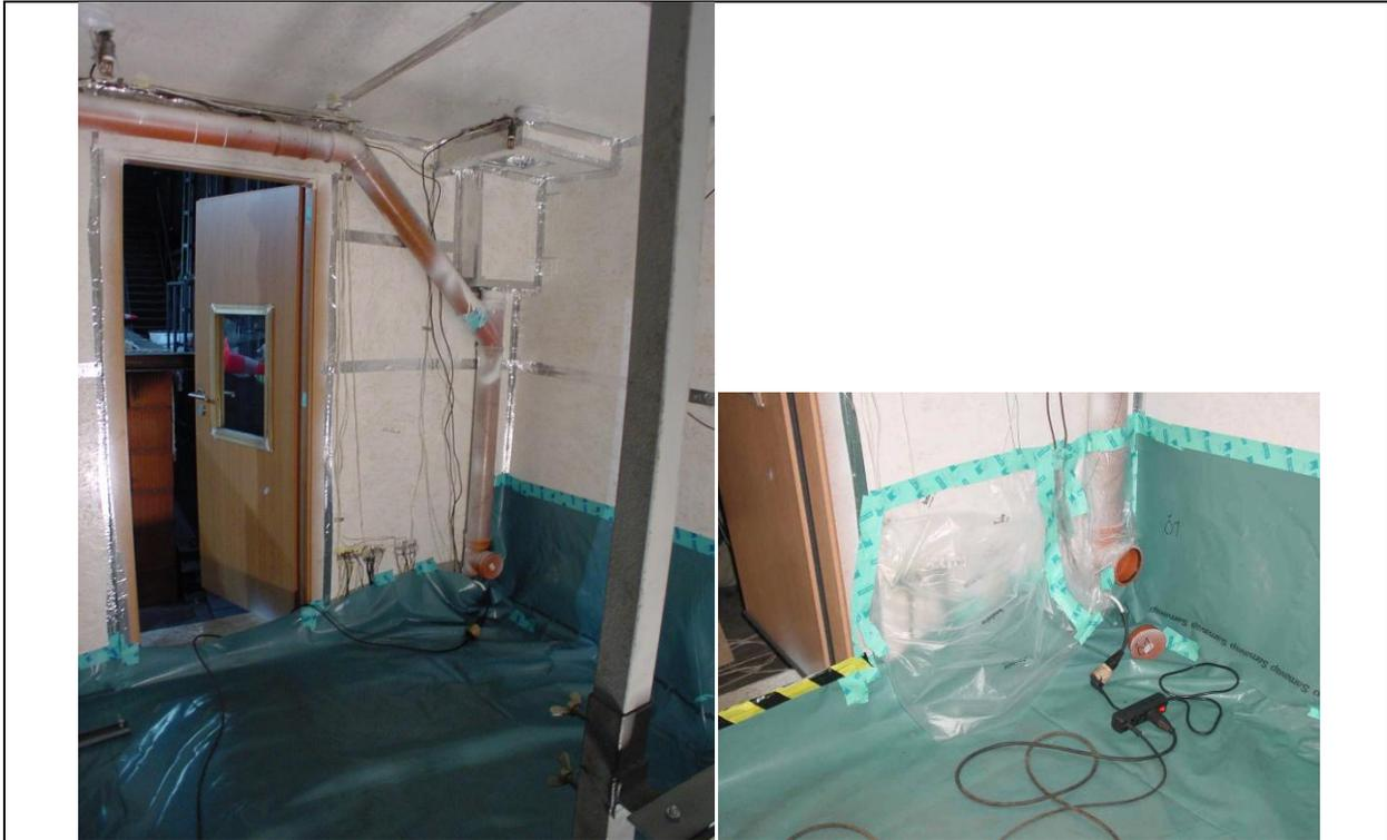
Abbildung 10: Versuchsraum - Eingangstür mit Beobachtungsfenster , Lüftungsöffnungen oben rechts an der Decke und unten rechts (nach Fertigstellung des Versuchsstandes).
