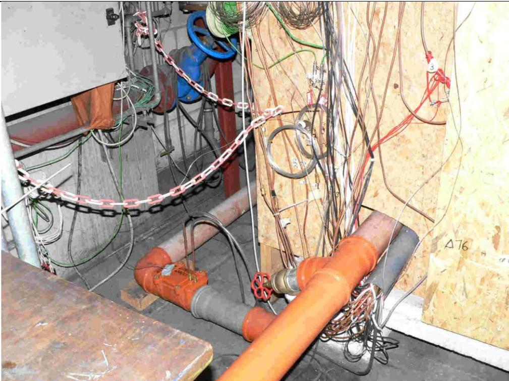
Abbildung 27: Einführung der Messleitungen und einer Lüftungsleitung in das Versuchslabor.
