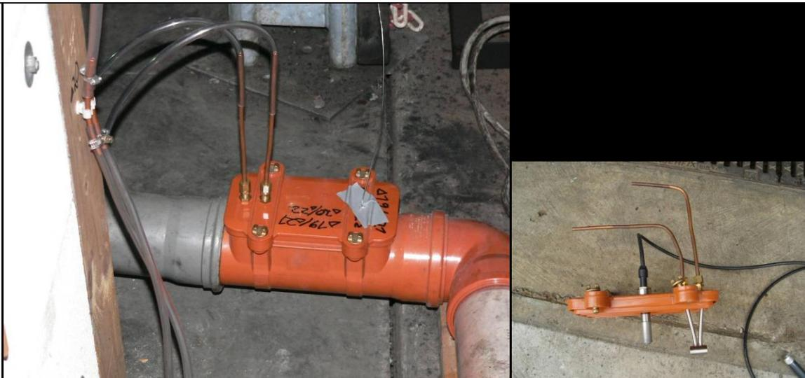
Abbildung 29: Messung von Temperatur, dynamischem Druck und relativer Luftfeuchtigkeit im Lüftungskanal.
