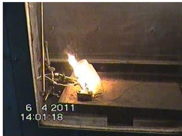
Abbildung 55: Schmelze des PP-Behälters brennt.
