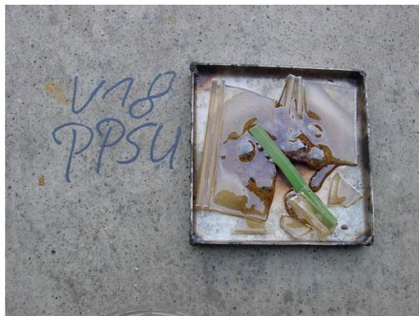
Abbildung 41: PPSU-Probekörper nach Versuchsende (V18).
