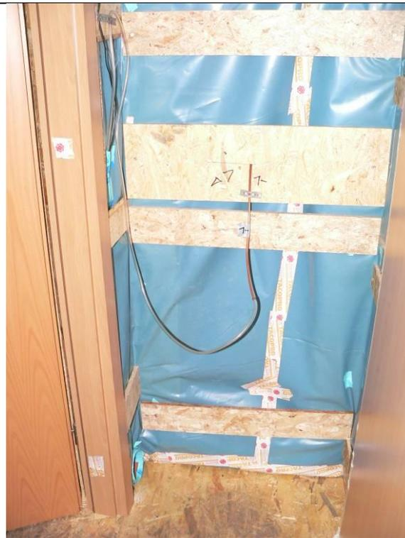
Abbildung 20: Schleuse – statische Differenzdruckmessung (Bild Mitte), Zuluftöffnung (Bild links unten).
