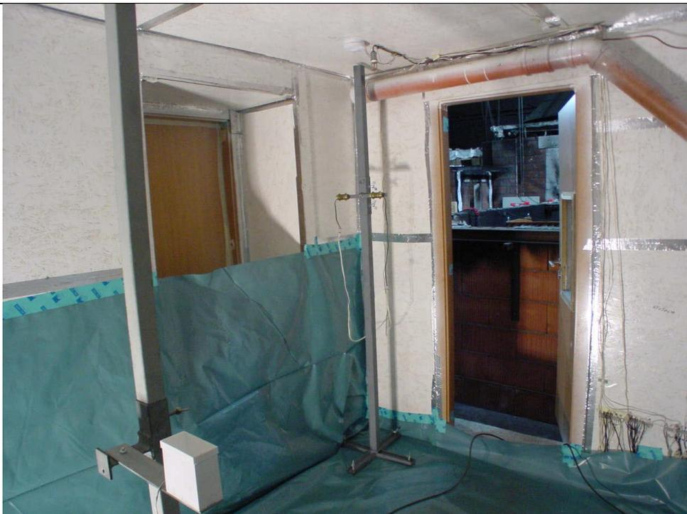
Abbildung 13: Eingangstür in das Versuchslabor und in die Schleuse (Folie zur Löschwasserrückhaltung), im Vordergrund Regenmesser auf Stativ (=>Messung der volumetrischen Wasserbeaufschlagung), Laser-Rauchdichtemesstrecke auf Stativ, Lüftungsöffnung sowie Rauchmelder und Indicatorsprinkler in der Ecke links oben.
