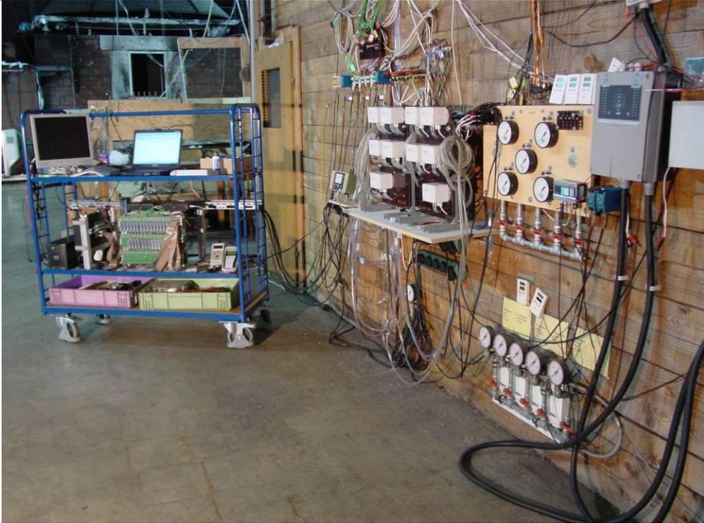
Abbildung 26: Messtechnik und Messdatenerfassung mit EDV, Anzeigetableaus und Messumformer für Temperatur, Rauchmelder, RAS (Melderkasten), Manometer für Indikatorsprinkler, Messumformer für Temperaturen, relative Luftfeuchtigkeit, statischer und dynamischer Druck, Regenmesser.
