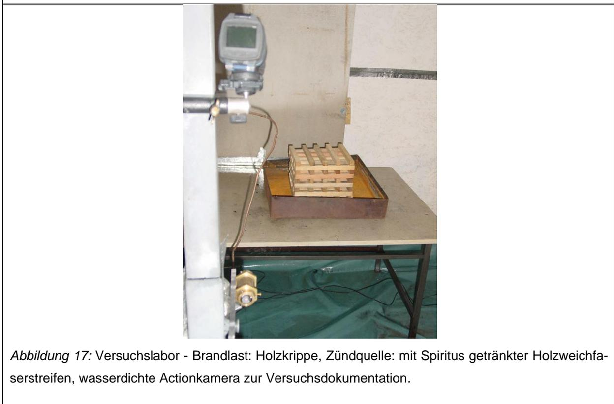
*Abbildung 17:* Versuchslabor - Brandlast: Holzkippe, Zündquelle: mit Spiritus getränkter Holzweichfaserstreifen, wasserdichte Actionkamera zur Versuchsdokumentation.
