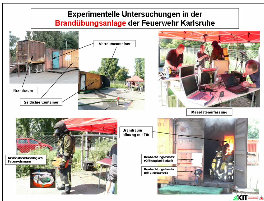
Bild A48: Versuchsaufbau und Messtechnik – 1 (FFB, Feuerwehr Ka)
