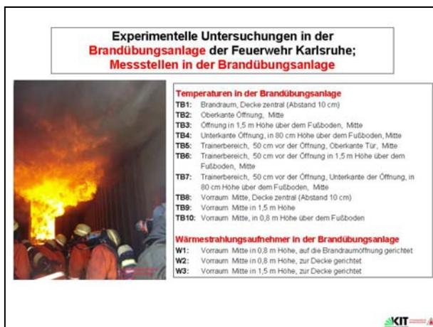
**Bild 29:** Messstellen in der Brandübungsanlage
