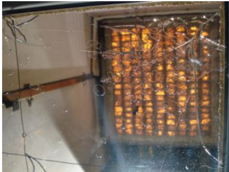
Abbildung 7-31: Blasen- und Fingerbildung der Folie bei Versuch FV2-11 (PVC-Rahmen, 2 fach Verglasung, äußere Scheibe VSG).
