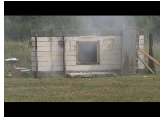
Verglasung nach dem Versuch
