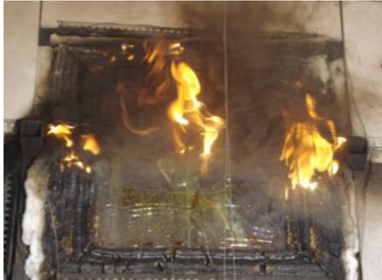
Abbildung 7-34: Flammenzungen bis zur Scheibenmitte, Rahmen brennt (Versuch FV2-11 (PVC-Rahmen, 2 fach Verglasung, äußere Scheibe VSG)).
