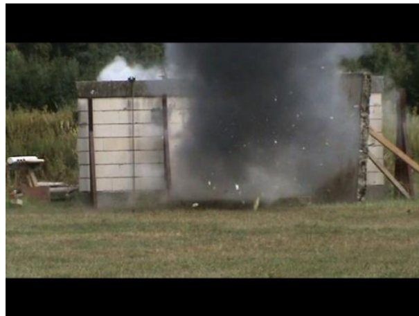
Abbildung 8-12: Versuch 1: Sprengung von VSG mit Sprengfolie
