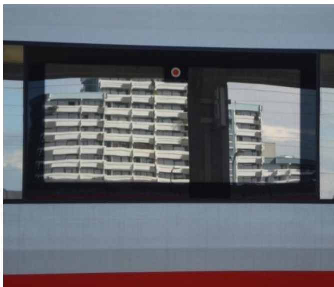
Abbildung 8-23: Außenansicht - ICE Fenster mit Sollbruchstelle
