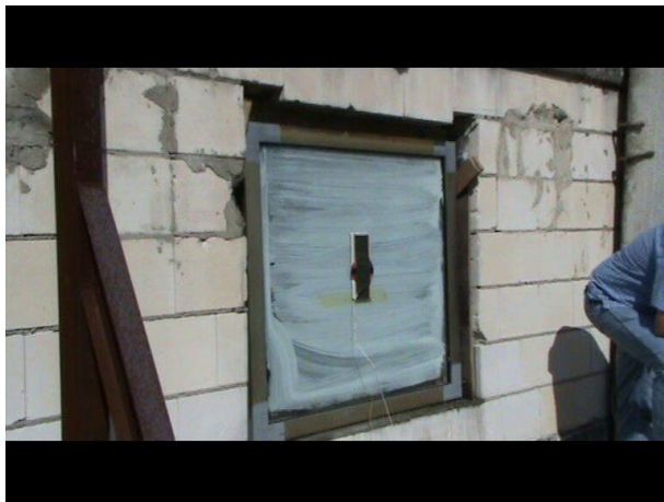
Abbildung 8-20: Versuch 9: Sprengung von VSG mit Sprengschnur, verdämmt
