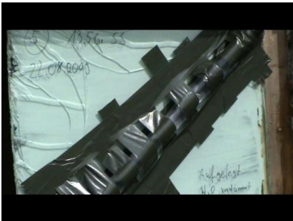
Abbildung 8-16: Versuch 5: Sprengung von VSG mit Sprengschnur, verdämmt
