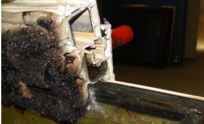
Abbildung 7-29: FV 1-4: Aufgeschnittener Rahmen (Temperaturniveau 1)
