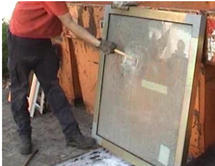
Abbildung 8-8: ESG - Scheibe zerspringt beim fünften Hammerschlag
