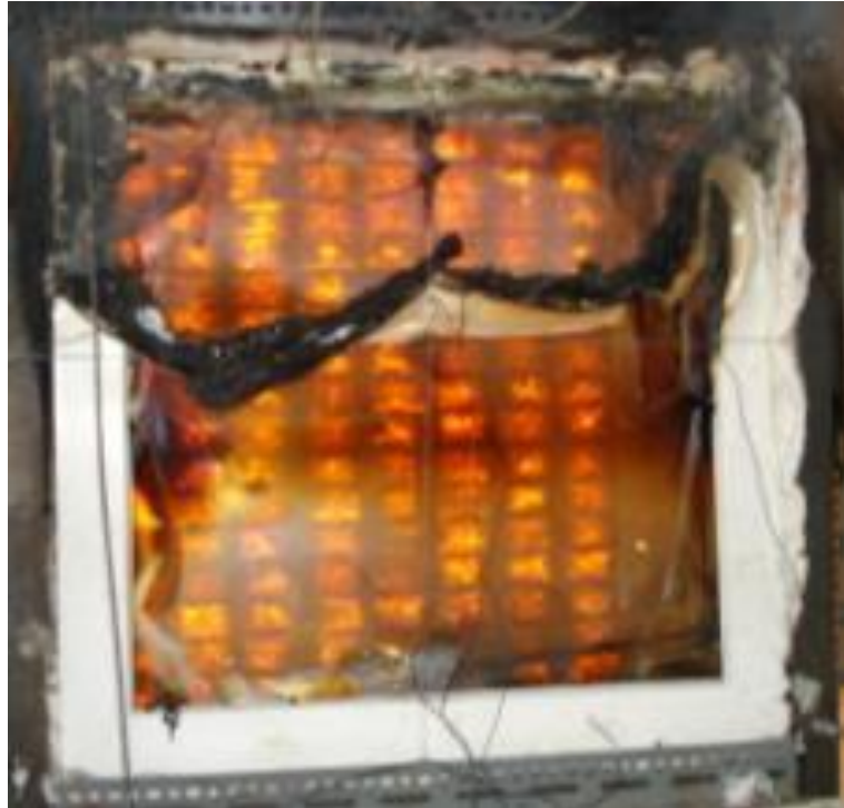
Abbildung 7-28: FV2- 8 PVC 2f – Fensterrahmen bei Versuchsende (Temperaturniveau 2)
