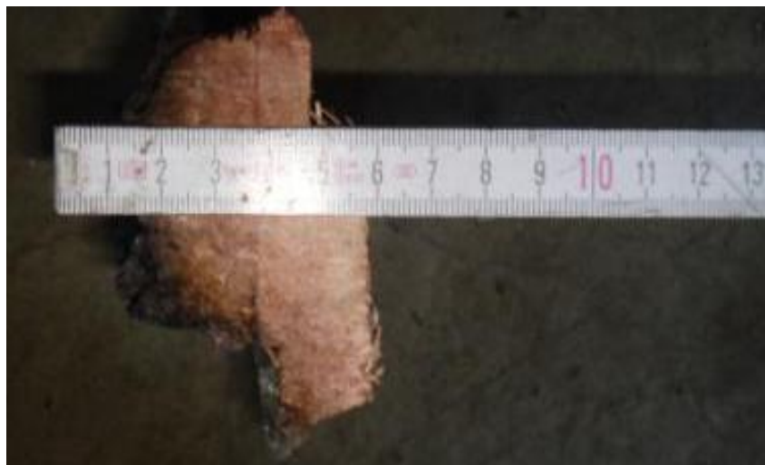
Abbildung 7-27: FV2-10 Holz,2f – Querschnitt des Holzrahmens nach Versuchsende (Temperaturniveau 2)
