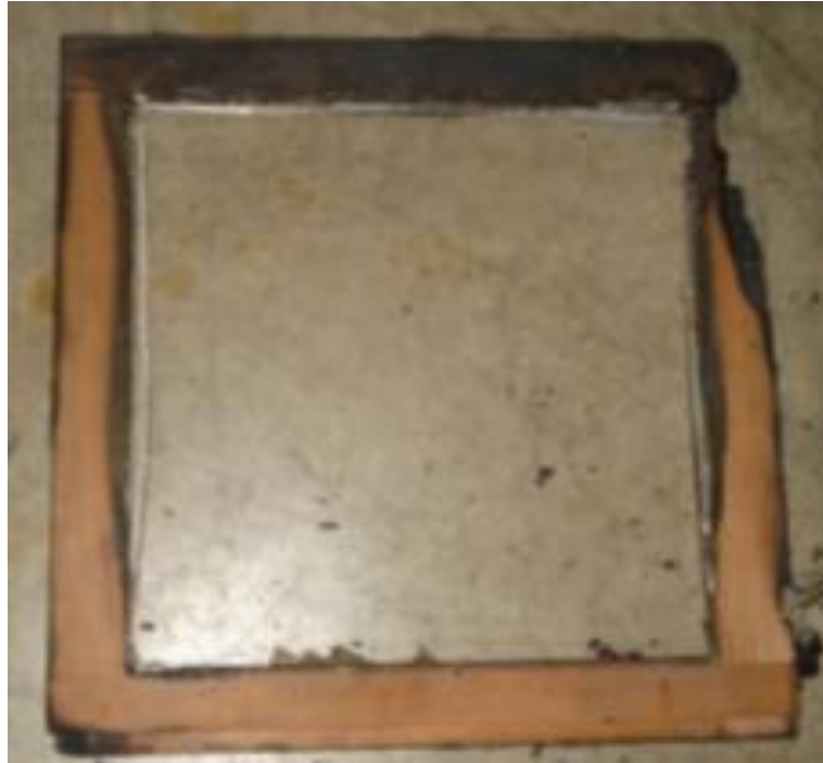
Abbildung 7-26: FV2-10 Holz,2f – Fensterrahmen bei Versuchsende (Temperaturniveau 2)
