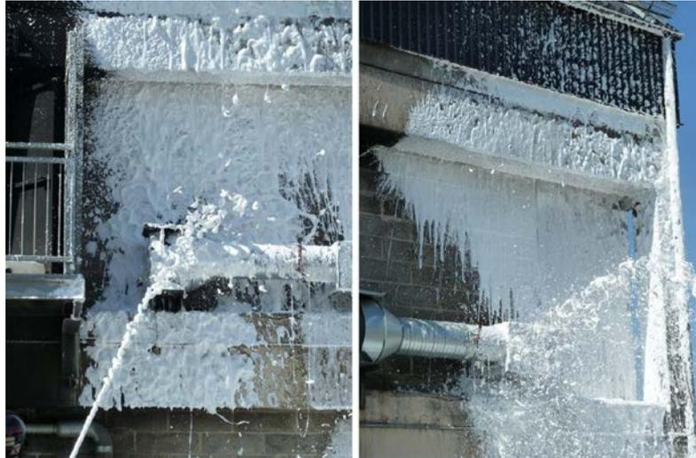
*Abbildung 11:* Beaufschlagung von vertikalen Flächen mit Druckluftschäum: Bild links: trockener Schaum, rechts: nasser Schaum [Lyckeback und Öhrn /2012/, /63/]
