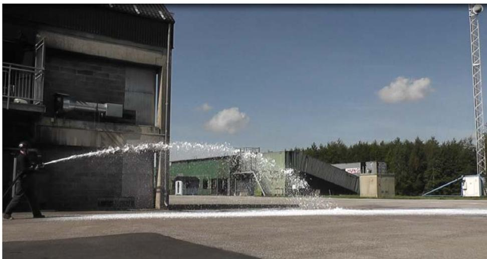
*Abbildung 10:* Wurfweite des ausgebildeten stationären Löschmittelstrahles bei nassem Druckluftschaum [Lyckeback und Öhrn /2012/, /63/]
