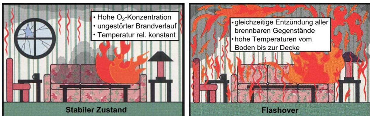
Abbildung 2.4: Entwicklung eines Brandes bis zum Flashover [6].
