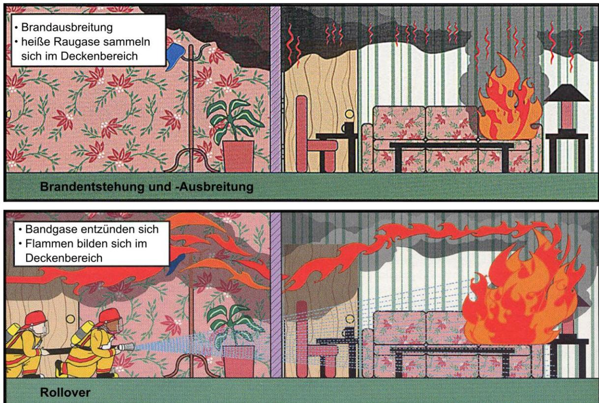
Abbildung 2.3: Entstehung und Verlauf eines Rollovers bei geöffneter Zimmertür [6].
