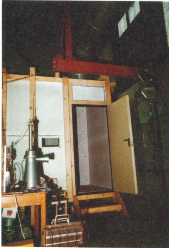
Bild 3: Schleuse mit Luftzuführung
