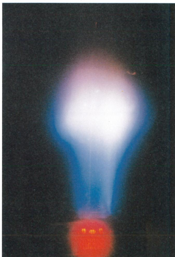
Bild 15. Spiritusflamme nach der Rückzündung in einem  $\text{CO}_2$  /Luft-Gemisch.
