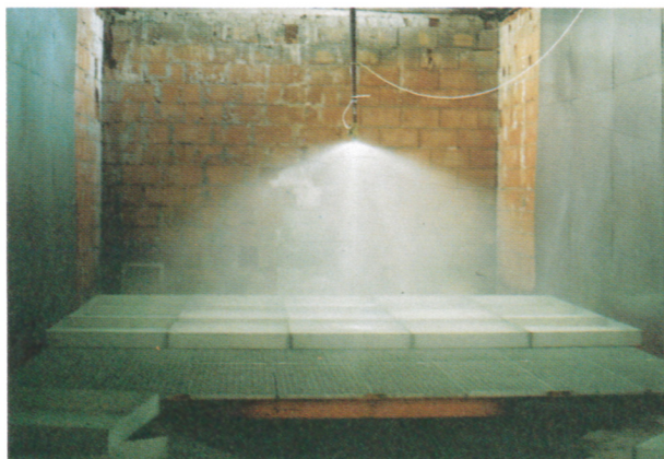
Bild 16a. Eine Sprinklerdüse im Einsatz in 1,50 m Höhe.
