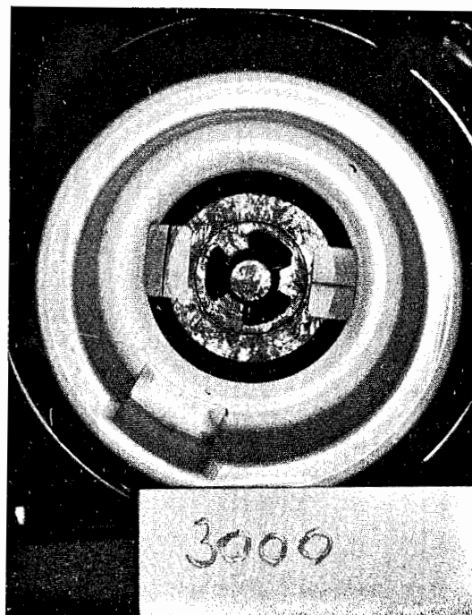
Bild 14. Aufnahme einer mit 49 m/s bewegten Markierung auf dem Flansch eines Motors, Kondensatorspannung 3000 V. Markierung wird scharf wiedergegeben.
