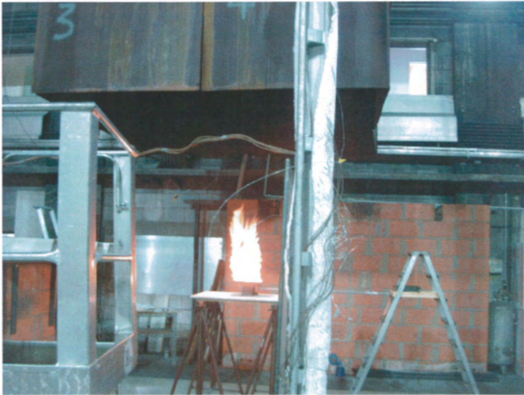
Abb. 32: Spiritusbrand unter der 3x3m-Abzugshaube. Zur kontinuierlichen Versorgung des Brandes wurde das Brandgutbecken über eine Rohrleitung mit einem Vorratsbehälter verbunden (rechts im Bild / auf der Leiter)
