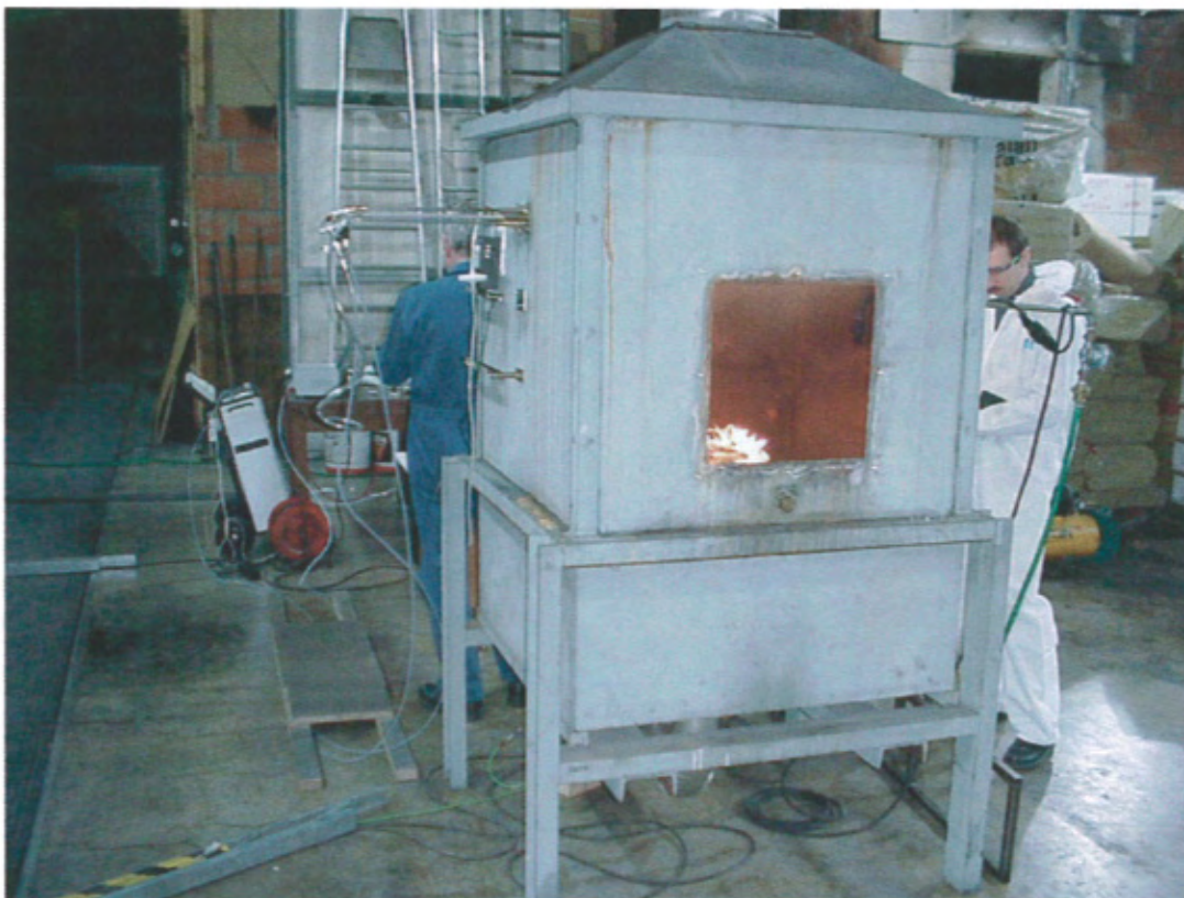
Abb. 26: Ansicht der Brandkammer zur Verbrennung/Pyrolyse der Proben während des Praxistests
