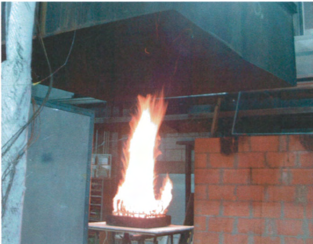
Abb. 33: Holzbrand unter der 3x3m-Abzugshaube.
