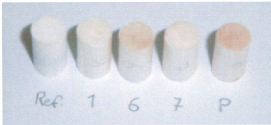
Abb. 21: Ansicht mehrerer Filter nach Pyrolyseversuchen in der Brandkammer. V.l.n.r.: Neuer Filter, nach Pyrolyseversuch Dächer 1, 6, 7, Computer-Platine (s. Abschn. 4.3.2)
