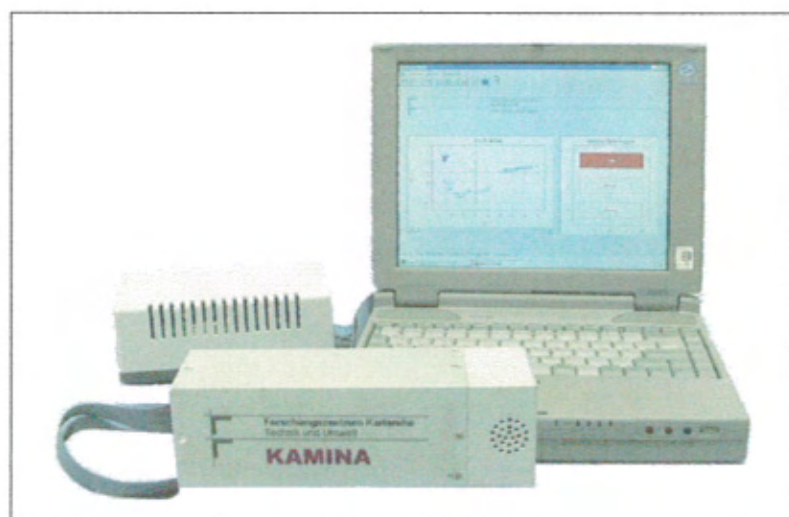
Abb.1: Derzeitiger Aufbau der KAMINA (Version II) mit mikrokontrollergesteuertem Betriebsgerät (Vordergrund), einem Notebook-PC zur Auswertung und zur Online-Datenanzeige sowie dem Netzteil.
