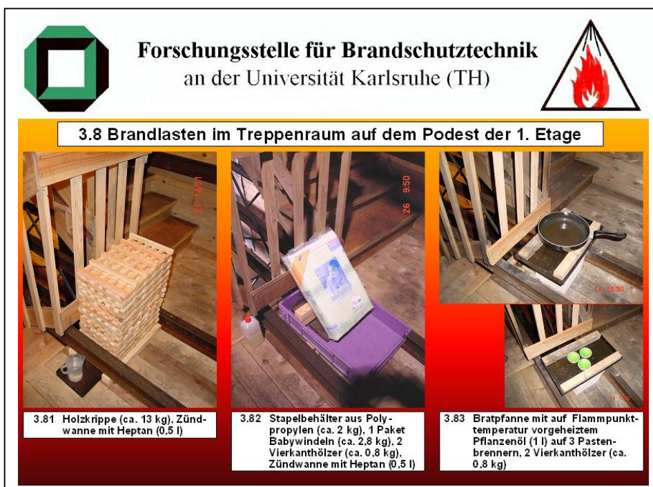
Bild 16: Brandlasten im Treppenraum
