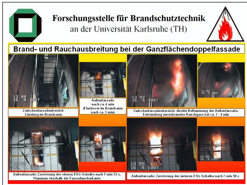
Bild 9: Brandversuch in einem Wohnzimmer mit vorgesetzter Ganzflächendoppelfassade
