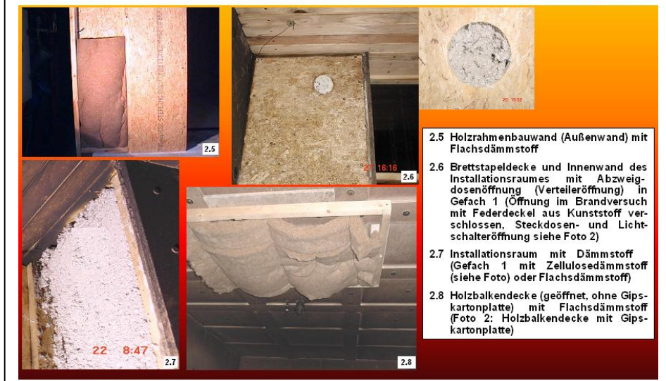
Bild 14: Versuchsholzgebäude – Brandraum: Wand- und Deckenkonstruktionen
