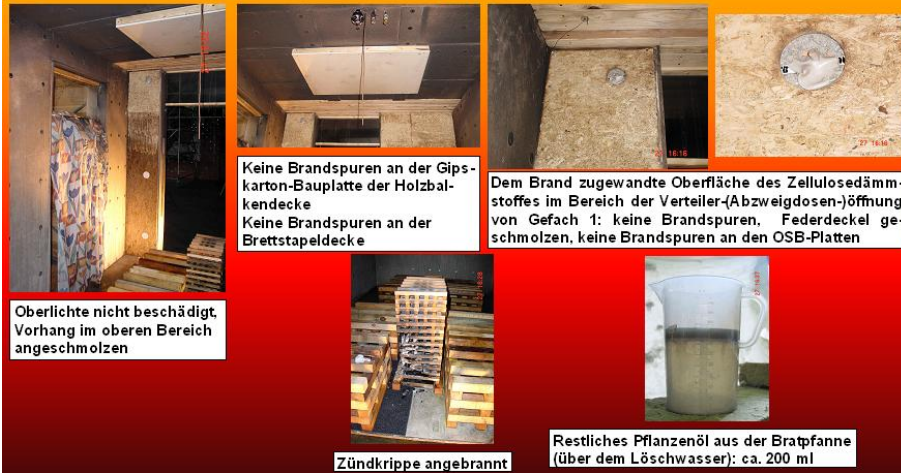
Bild 21: Brand- und Löschversuch mit schneller Auslösung der Niederdruck-Wasserebellöschanlage im Brandraum
