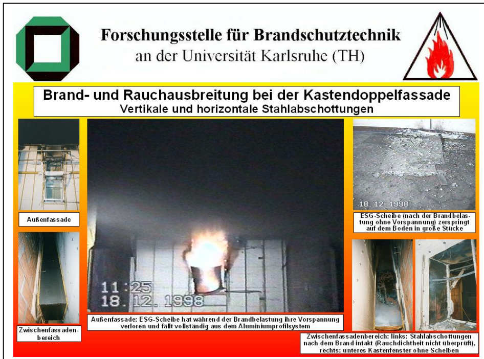
Bild 10: Brandversuch mit einer Kastendoppelfassade
