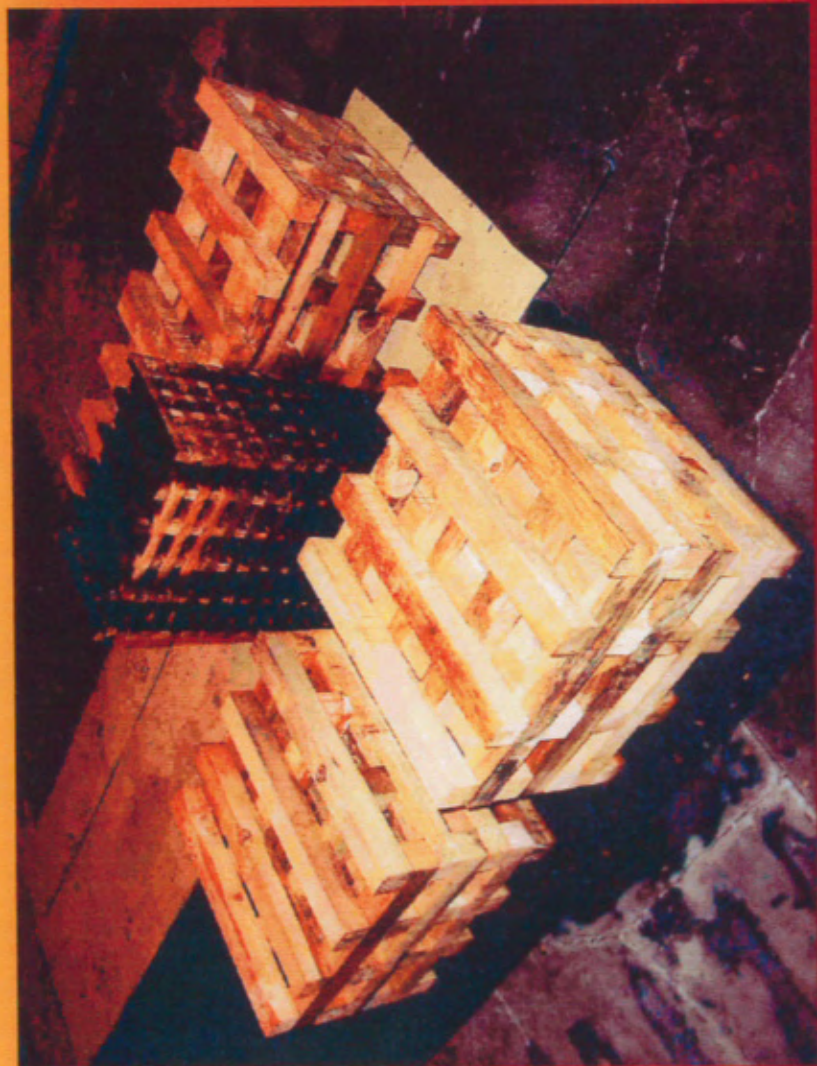
Bild 32: Versuch 2 - mit Niederdruck-Wassernebellöschanlage, ohne thermische Entlastungsöffnung - Brandschäden und Gefährdungen
