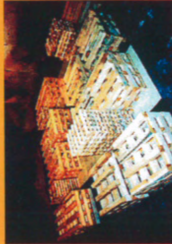
Brandlast: ca. 336 kg (Holzkrippen: ca. 314 kg, Linoleum: ca. 19 kg, Nadelfilzteppichboden: ca. 2 kg, Heptan: 1 l)
