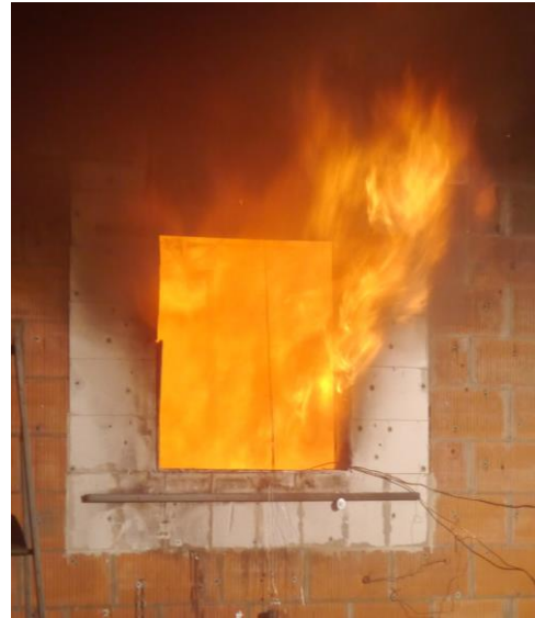
Abbildung 67: Rauchgasdurchzündung aufgrund Frischluftzufuhr nach 16:52 Minuten
