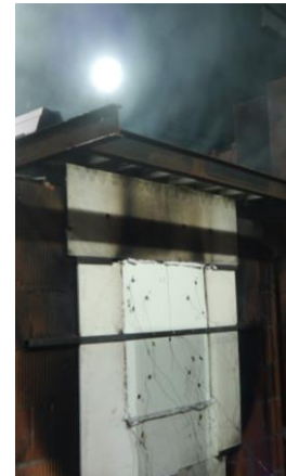
Abbildung 45: Versuchsbild, Kiesbettbrenner und Wabenfüllung
