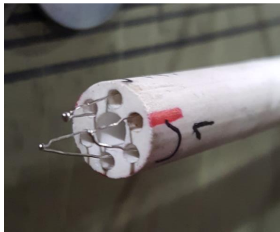
Abbildung 26: Bild der Drei-Perlensonde
