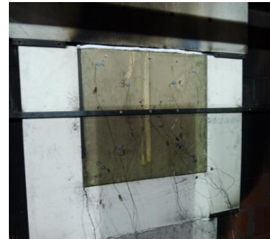
Abbildung 55: Versuchsbild, Kiesbettbrenner und Stahltür
