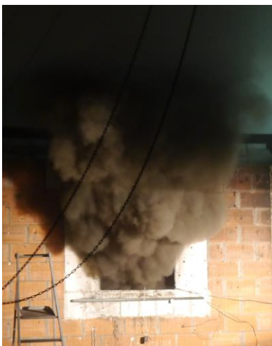
Abbildung 64: Unvollständige Verbrennung durch das brennende Sofa nach 13 Minuten
