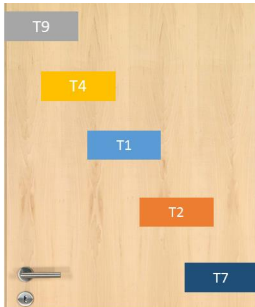
Abbildung 41: Anordnung der Thermoelemente flammenzugewandte Seite
