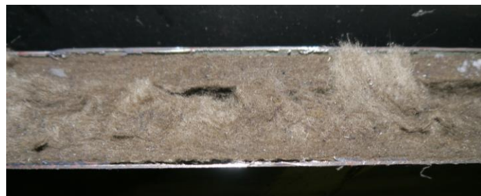
Abbildung 31: Bild des Innenlebens der Stahltür, Türblatttiefe 4 cm
