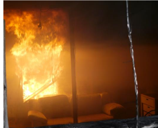
Abbildung 61: Vollbrand der Wohnwand nach 5:20 Min.
