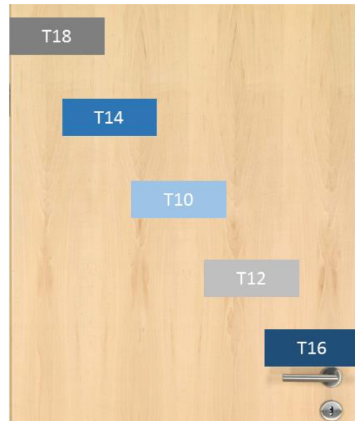
Abbildung 42: Anordnung der Thermoelemente flammenabgewandte Seite
