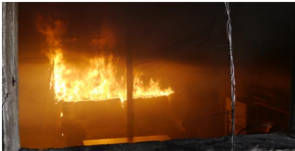
Abbildung 62: Entzündung der Couch nach 9 Min.
