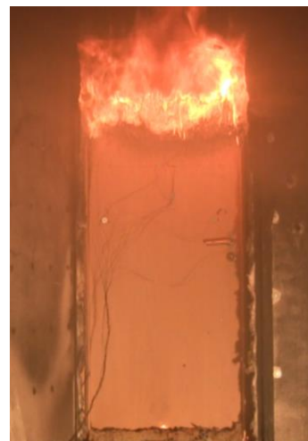
Abbildung 65: Durchbrand der Tür nach 14 Minuten
