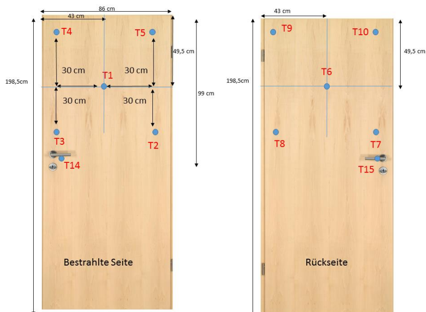
Abbildung 59: geänderte Anordnung der Thermoelemente für den Großbrandversuch
